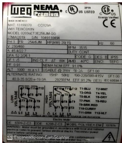
Figura 24. Datos de placa del motor de la bomba a monitorear Fuente: Elaboración propia (2022).
