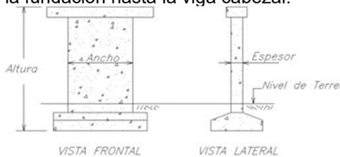
Figura 21. Pila tipo muro
