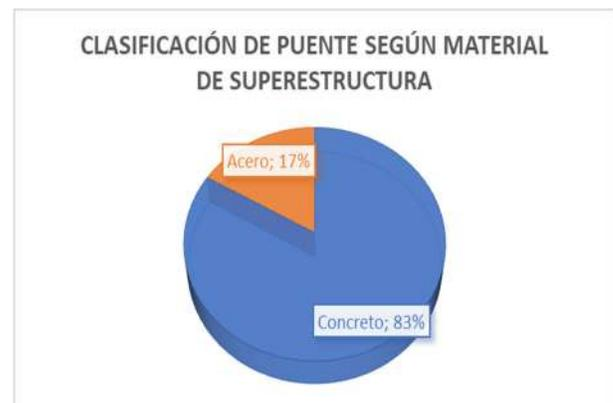
Figura 44. Clasificación de puente según material de la superestructura
