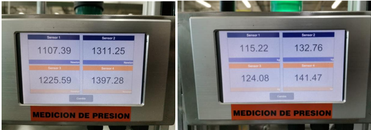
Figura 23. Valores de presión en el sistema de resortes y celdas de carga en tiempo real.
