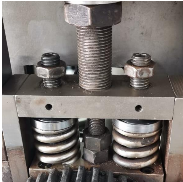
Figura 22. Sistema de resortes y celdas de carga instalados en la máquina SynchroFlo 1 .
