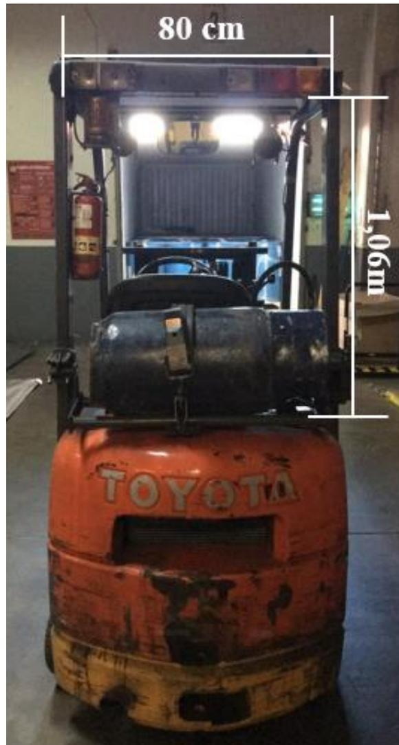
Figura 10. Dimensiones traseras del montacargas
