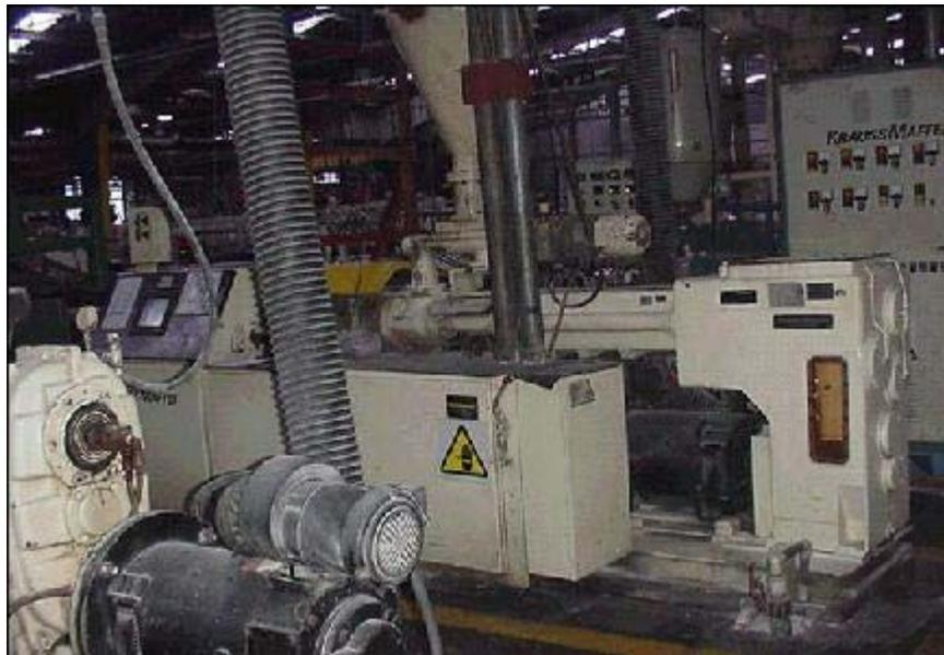
**Figura 2.1** Fotografía de la máquina extrusora para la cual se realizó el proyecto
