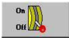
Este botón se encuentra en todas las páginas gráficas de los diferentes módulos, con este botón se apaga el motor principal de la máquina extrusora y con ello se detiene el proceso de extrusión. Por seguridad, no es permitido a través del sistema remoto, encender el motor principal.
