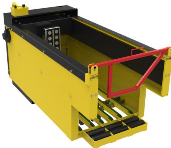
Figura 2. Equipo de intercambio de baterías.
