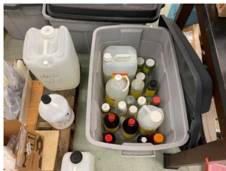
Figura 18. Residuos químicos almacenados en bandejas contenedoras sin segregar en un laboratorio de investigación de UCF (Foto tomada por los autores).
