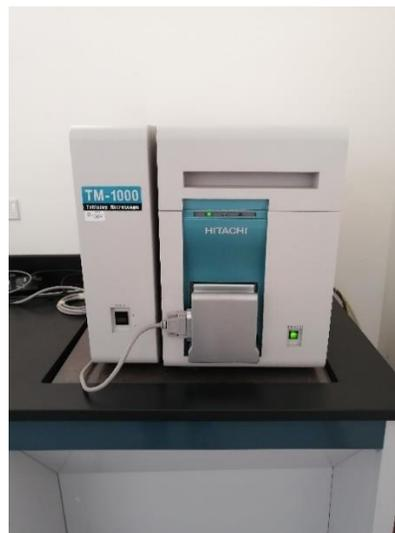
Figura 9. Microscopio Electrónico de Barrido modelo TM-1000.
