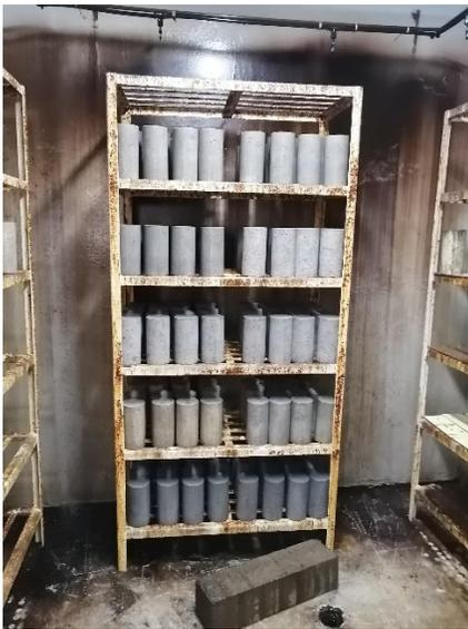
**Figura 18.** Curado de los especímenes en la cámara húmeda.
