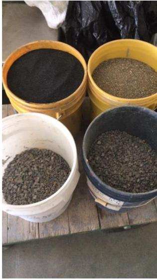
**Figura 12.** Materiales pesados para una mezcla de concreto hidráulico.
