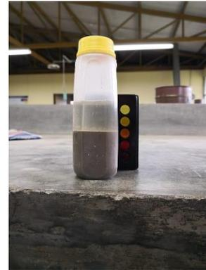
**Figura 5.** Comparación de la muestra con la escala de color.
