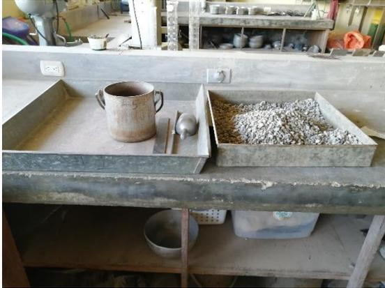
**Figura 6.** Equipo utilizado para determinar el peso unitario del agregado.
