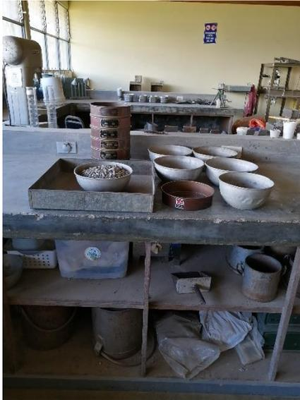
**Figura 4.** Equipo utilizado para el análisis granulométrico del agregado grueso.
