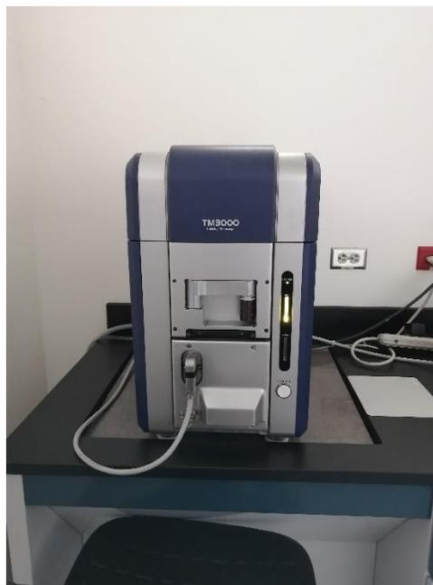
Figura 8. Microscopio Electrónico de Barrido modelo TM-3000.
