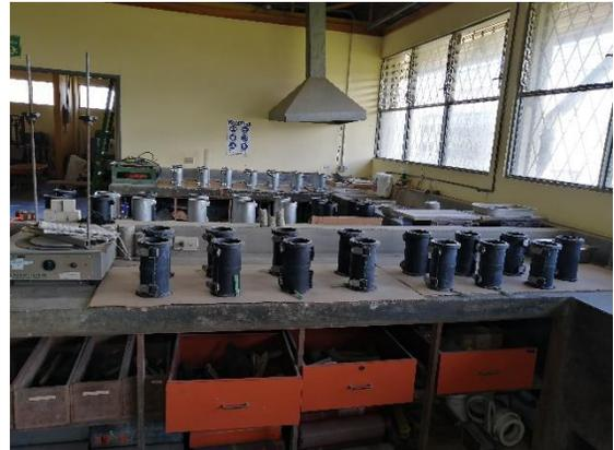
**Figura 11.** Zona de trabajo lista para el moldeo de los especímenes de concreto.
