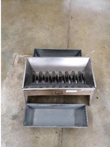
**Figura 3.** Divisor mecánico para agregados grueso.
