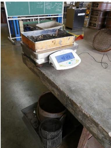
**Figura 7.** Determinación de la masa saturada superficie seca del material.
