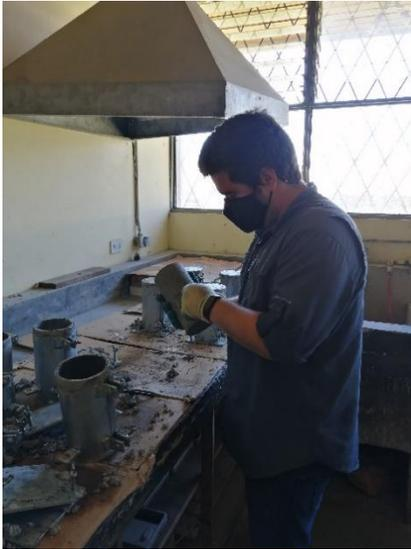
**Figura 17.** Desmolde e identificación de los especímenes.
