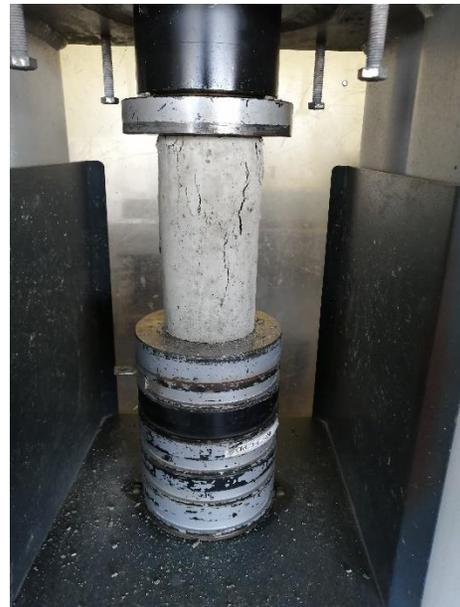
**Figura 20.** Especimen de concreto fallado a compresión.
