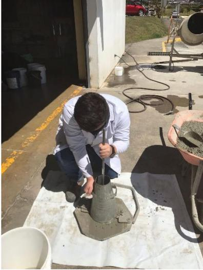
**Figura 14.** Elaboración del ensayo para determinar el asentamiento.
