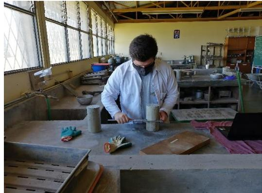
**Figura 19.** Determinación de las dimensiones del espécimen de concreto.
