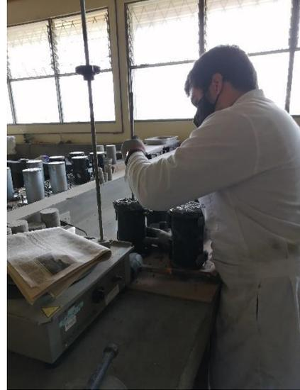
**Figura 15.** Compactado de los especímenes de concreto.
