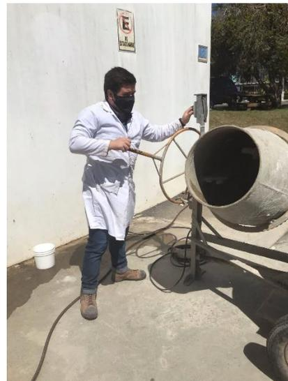
**Figura 13.** Elaboración de una mezcla de concreto hidráulico.
