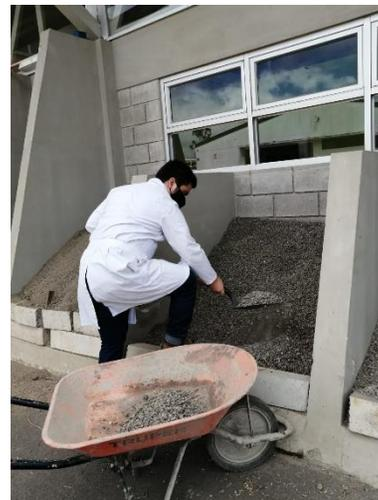
**Figura 2.** Muestreo del agregado grueso.
