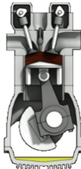
Figura 1. Un motor de cuatro tiempos [24]
