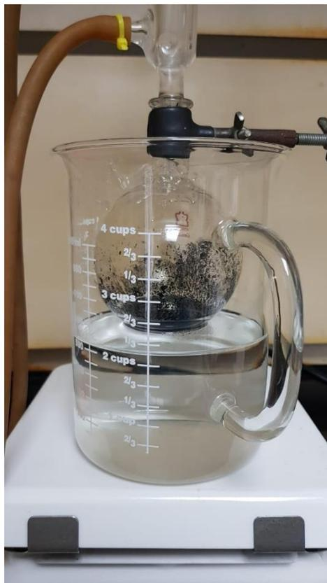
**Figura 11.** Equipo experimental para llevar a cabo la funcionalización de los CNTs
