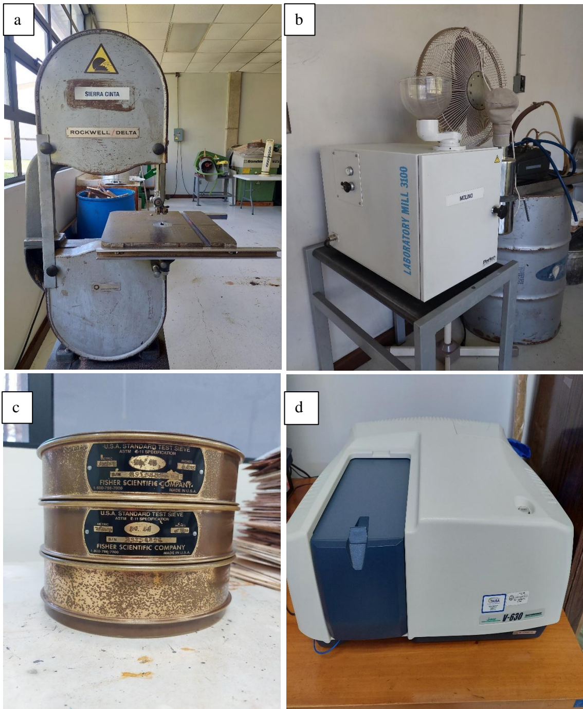
Anexo 1. Equipo utilizado, sierra cinta (a), molino (b), tamiz (c) y espectrofotómetro (d)
