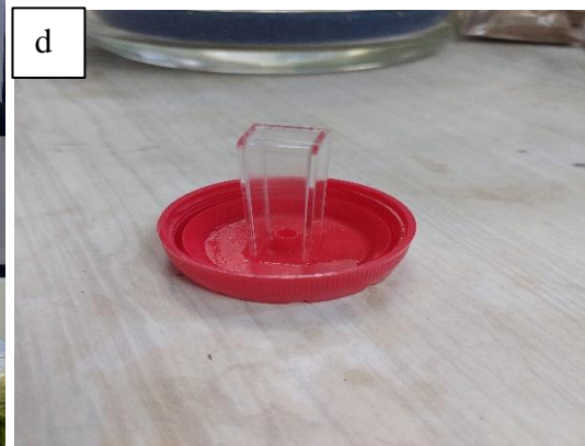
Anexo 3. Equipo utilizado, balones aforados (a), horno (b), plantilla y condensadores (c) y recipiente de cuarzo para muestra en espectrofotómetro (d).
