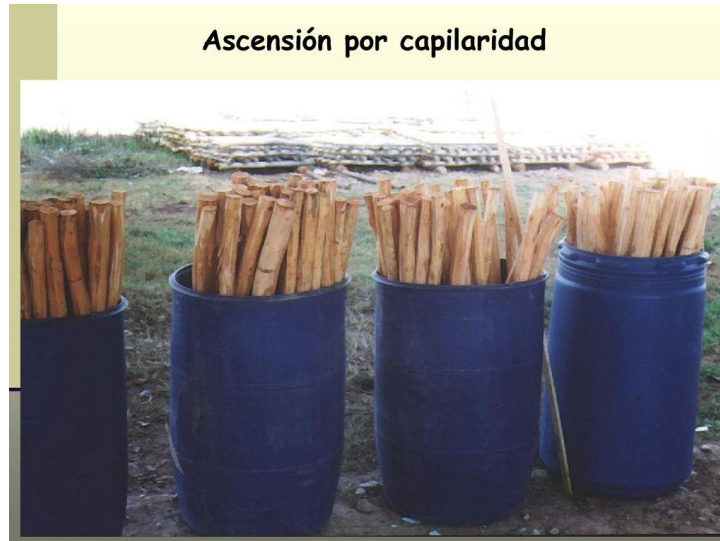
Figura 3. Preservación con el método de ascensión (Fuente Calderón A, 2018).
