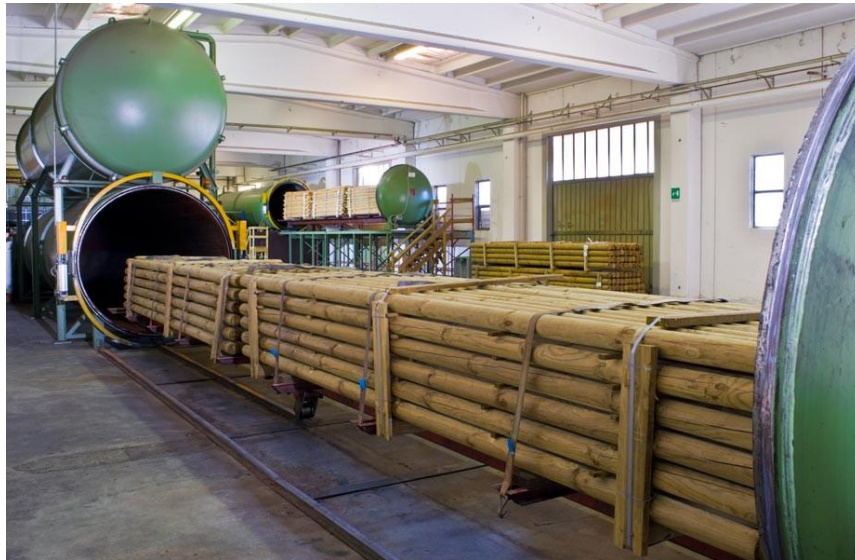
Figura 4. Ejemplo de preservación a presión con el uso de autoclave (Fuente ISVE Wood, s.f.).
