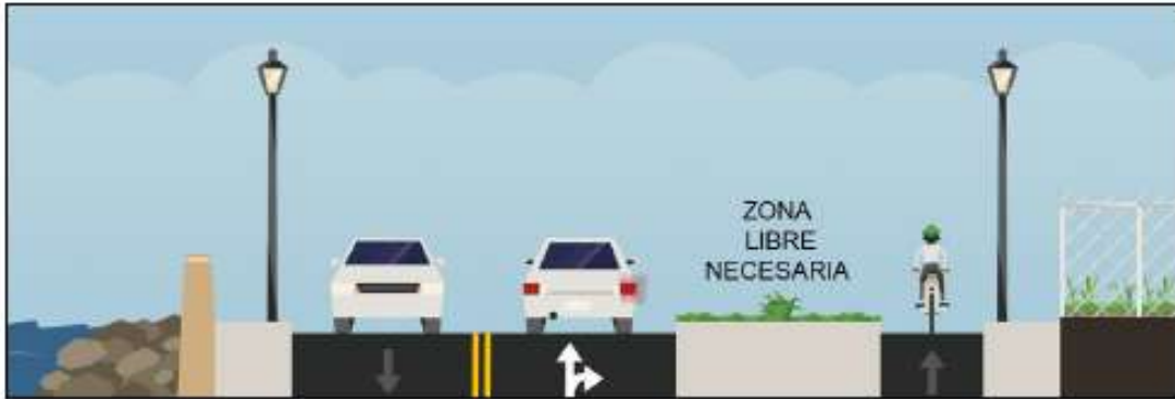
Figura 8. Segregada tipo 2 con zona libre necesaria Fuente: Murillo, 2019
