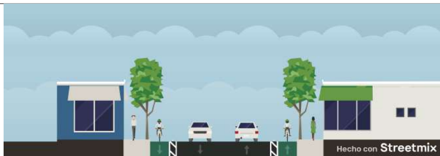
Sección transversal de infraestructura unidireccional
