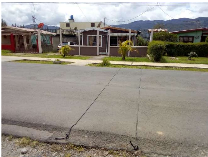
(b) Instrumento colocado en sitio para medir los conteos. Fuente: Brindada por el técnico del CIVCO Luis Carlos Calvo.
