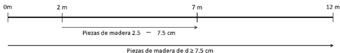
**Figura 3.** Representación del plano de intersección de 12 m de largo utilizado para medir madera caída en bosques de manglar. Fuente: (Cifuentes-Jara et al., 2018).
