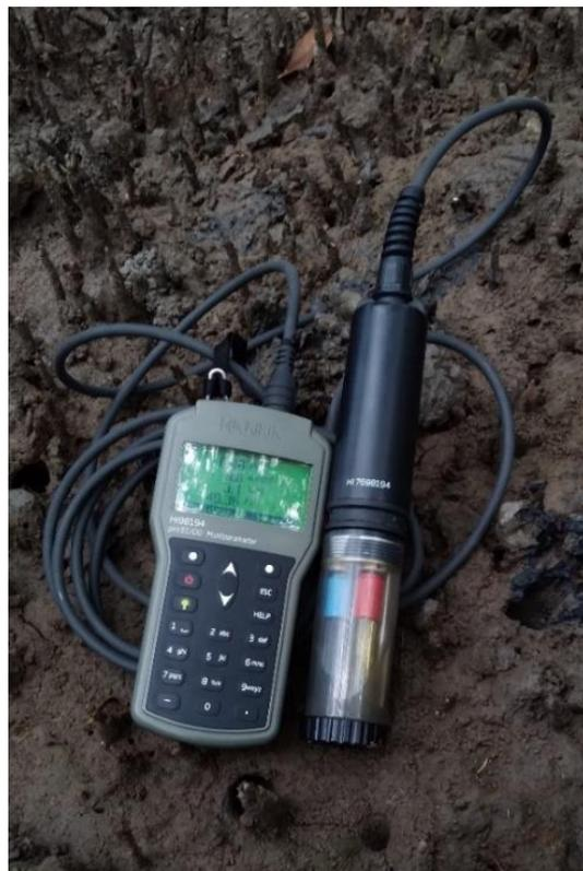
**Figura 4.** Medidor multiparámetro portátil HI98194 con sonda utilizado en los muestreos de agua intersticial en los humedales Nispero y San Buenaventura-Colorado, Golfo de Nicoya, Costa Rica, 2021.
