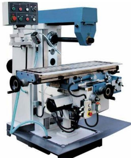
*Figura 2- 1: fresadora convencional.*
