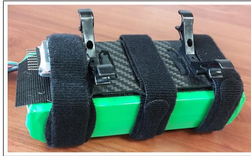
**Figura D.6:** Batería implementada y sujeta con fajas con velcro.
