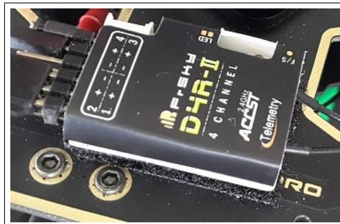
Figura D.5: Receptor de radio control sujeto con velcro adhesivo implementado.
