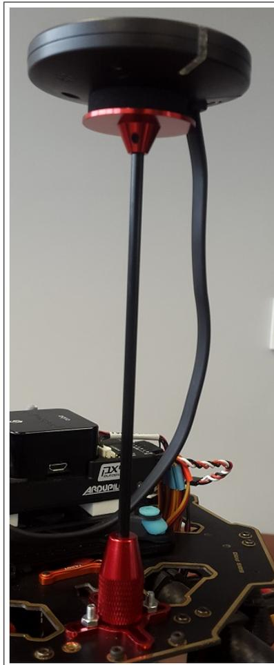
**Figura D.9:** Montura plegable del módulo GPS implementada.
