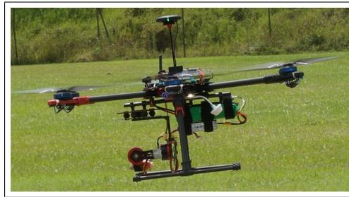
Figura D.4: Riel de montura con batería y gimbal.
