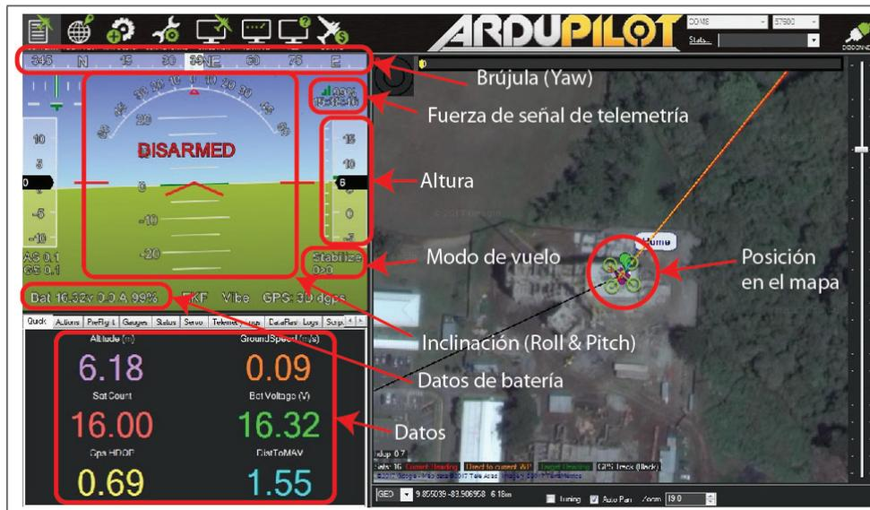
**Figura 4.2:** Enlace de telemetría entre UAV y GCS mediante el software Mission Planner.
