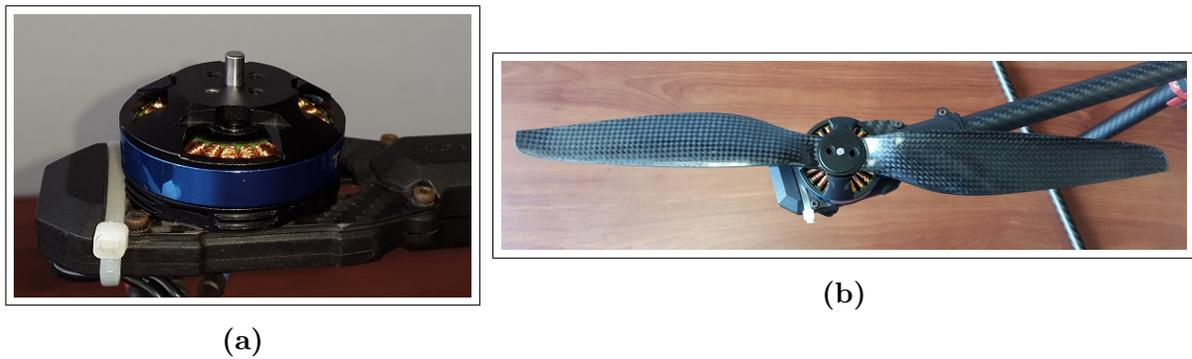
**Figura 3.9:** (a) Motor Tarot 4006 con 620 KV. (b) Propela de 13" con inclinación de 5.5"
