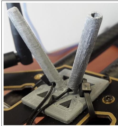
**Figura D.7:** Sostenedor de antena implementado.
