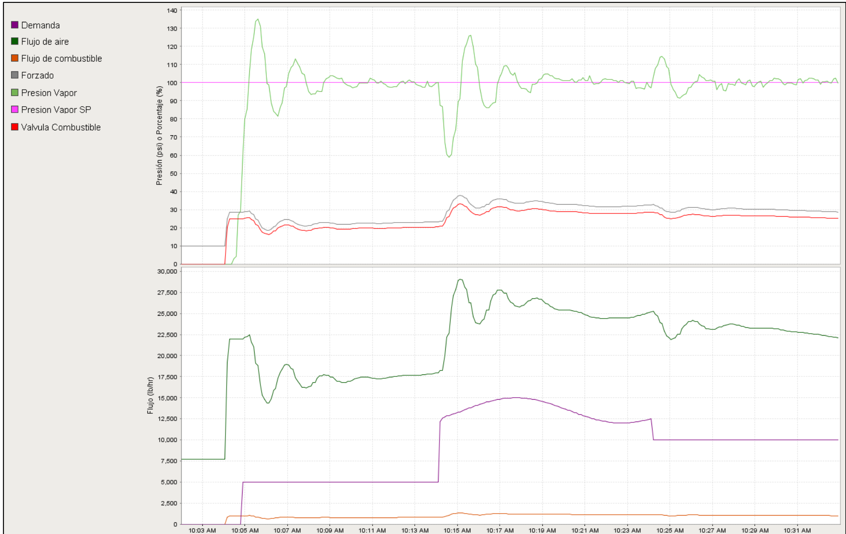
Figura 4. 11. Simulación del control de combustión de un eje usando el control de nivel de tres elementos. (Tomado de Ignition SCADA)
