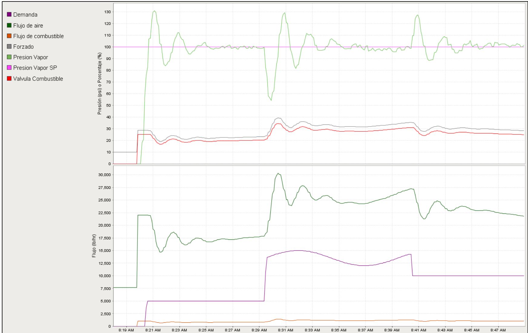
Figura 4. 7. Simulación del control de combustión de un eje usando el control de nivel de un elemento. (Tomado de Ignition SCADA)
