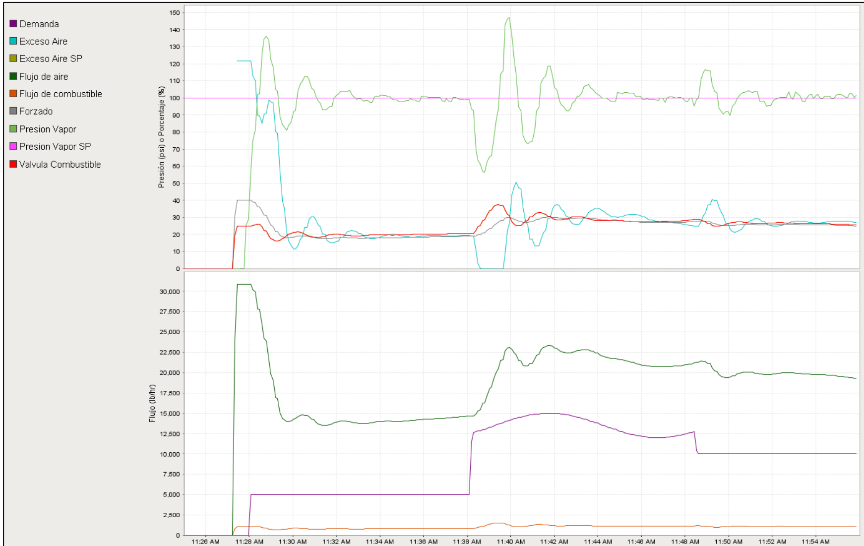
Figura 4. 12. Simulación del control de combustión de dos actuadores usando el control de nivel de tres elementos. (Tomado de Ignition SCADA)
