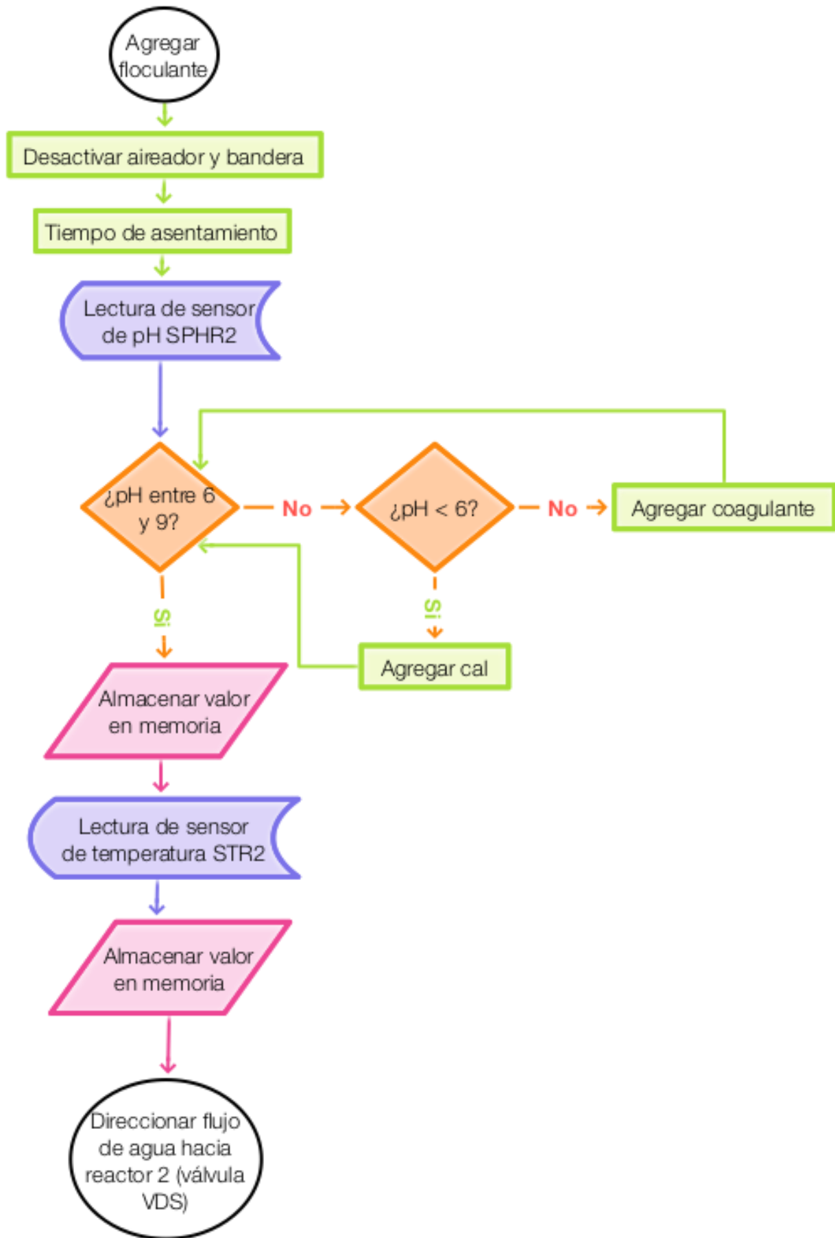
Figura 4.12. Segunda parte del diagrama de flujo de tratamiento de agua en reactor 2 elaborado con Grafió
