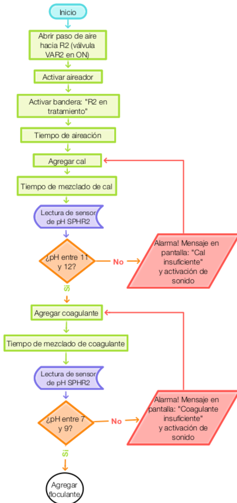
Figura 4.11. Diagrama de flujo de tratamiento de agua en reactor 2 elaborado con Grafo
