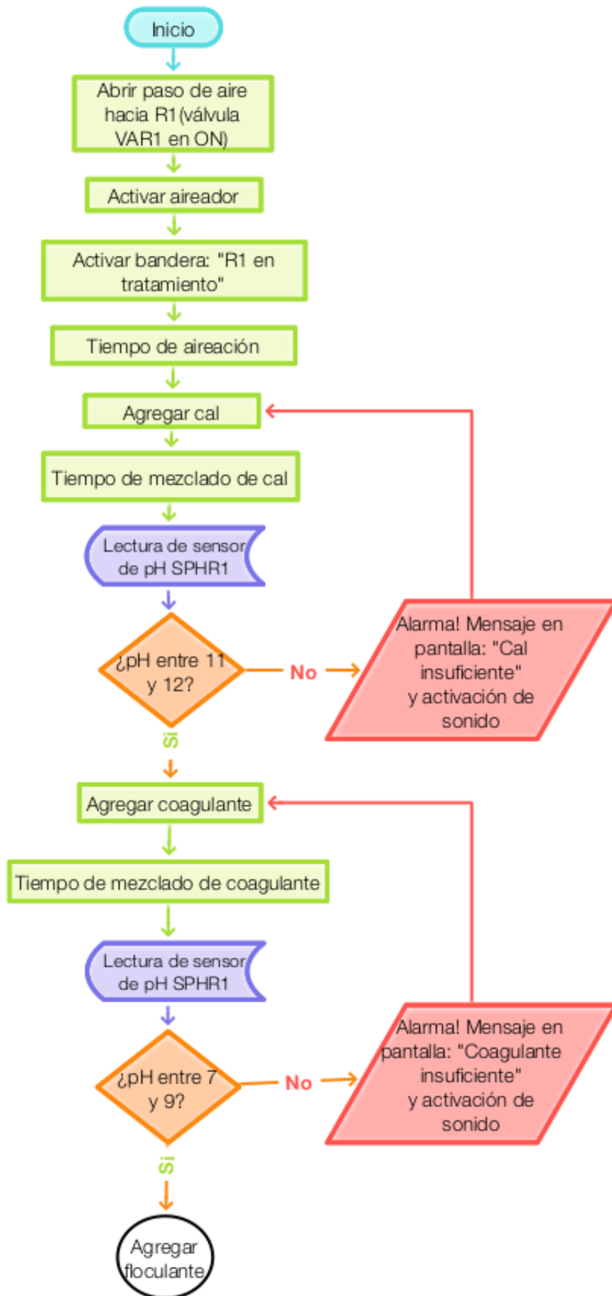
Figura 4.8. Diagrama de flujo de tratamiento de agua en reactor 1 elaborado con Grafió
