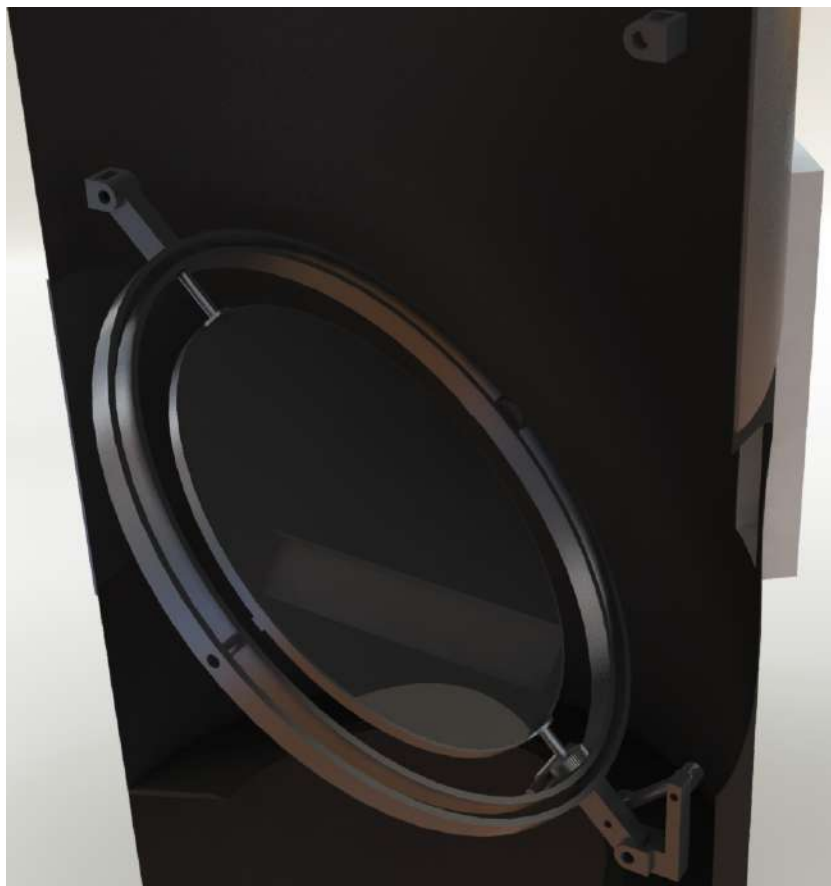
Fig. 10.12: Corte del deflector con acople en operación hacia el Oeste
