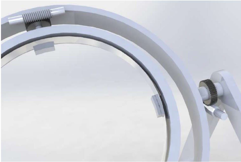
Fig. 10.2: Tornillo sin fin y corona para la inclinación y guiñada del espejo terciario
