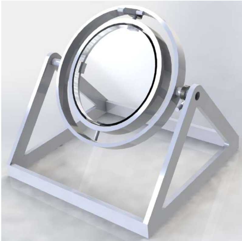
Fig. 10.1: Propuesta soporte espejo con movimiento de inclinación y guiñada
