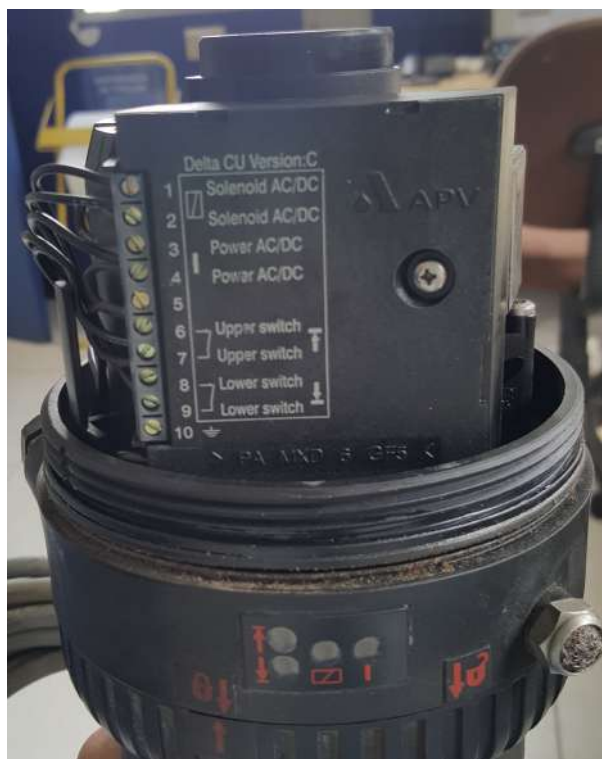
Figura 3.13: Unidad de control de la válvula para el agua. Fuente: Elaboración propia
