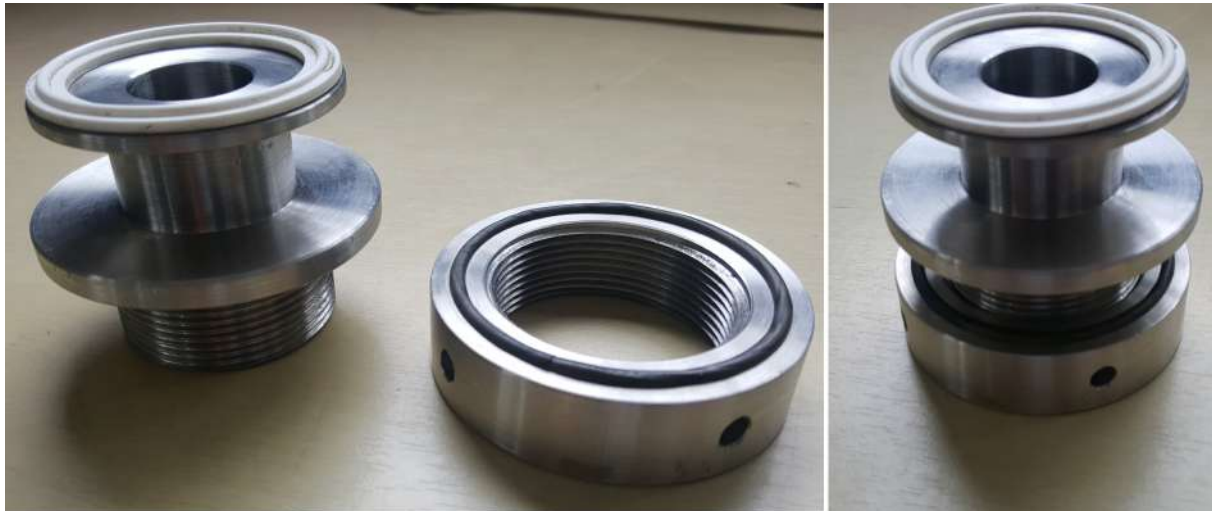
Figura 3.9: Detalle de la pieza para el acople de la sonda con el tanque. Fuente: Elaboración propia
