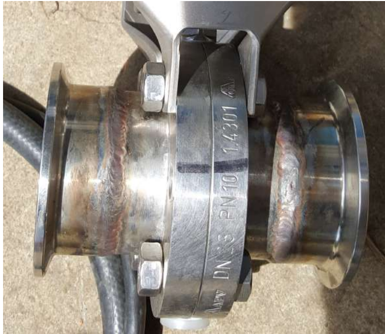
Figura 3.5: Adaptación para acoplar la válvula de control de flujo de agua. Fuente: Elaboración propia
