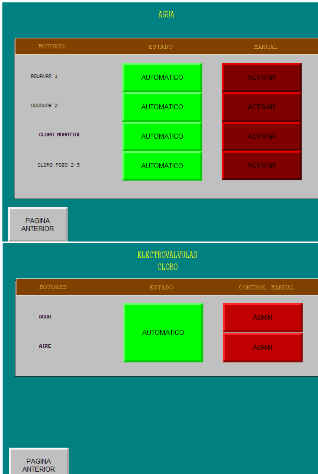
Figura 3.33: Comparación de las pantallas 12- MOTORES AGUA y 15- ELECTROVALVULAS CLORO. Fuente: Elaboración propia
