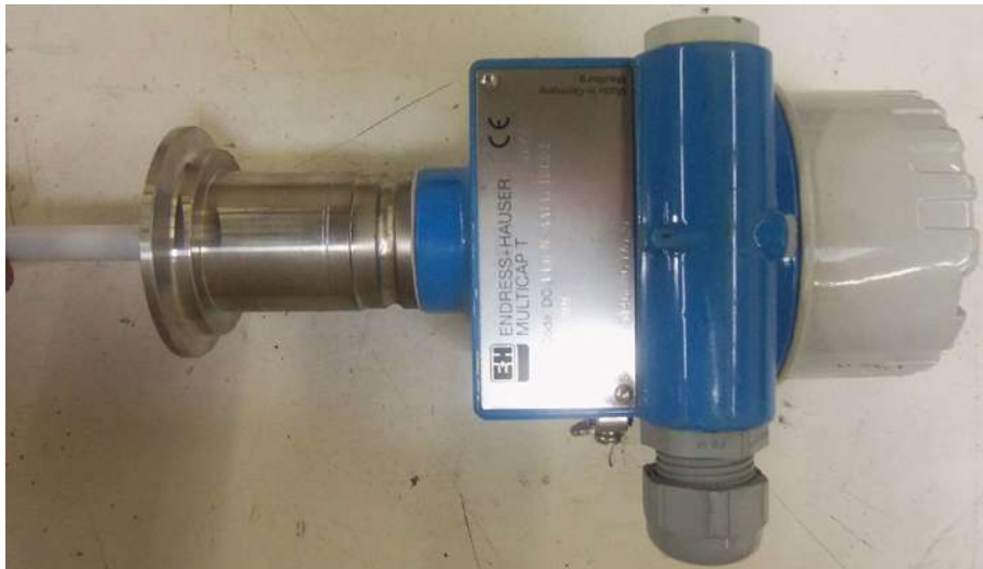
Figura 3.8: Sonda capacitiva de nivel Endress Hauser Multicap T. Fuente: Elaboración propia
