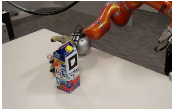
Figura 4.11: Configuración de brazo y mano con la caja para realizar experimentos [1].
