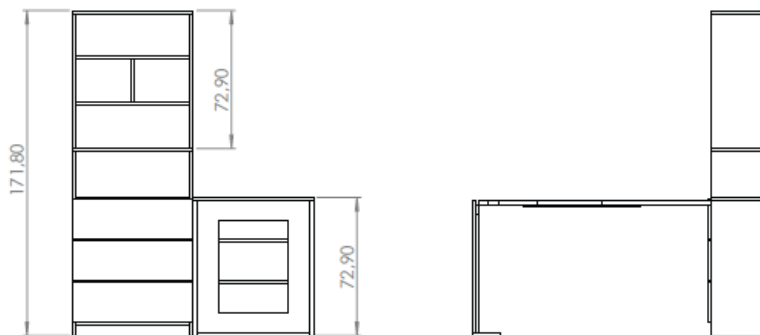
Fig. 71. Vista frontal y lateral del mueble con dimensiones. Elaboración propia.
