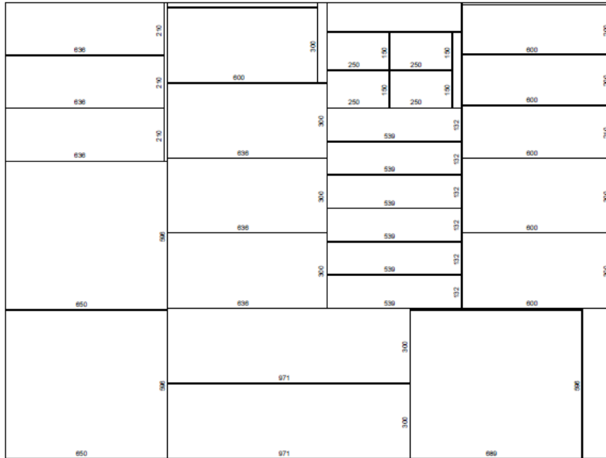
Fig. 61. Distribución de piezas sobre láminas 1
