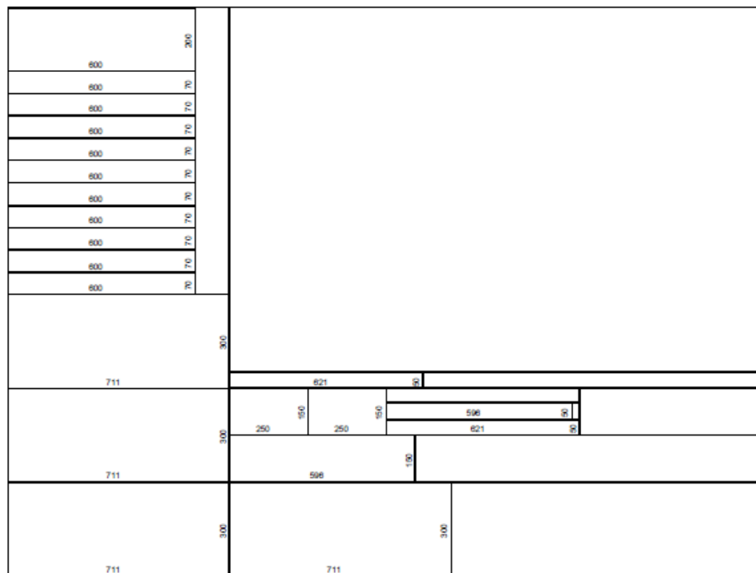
Fig. 62. Distribución de piezas sobre láminas 2
