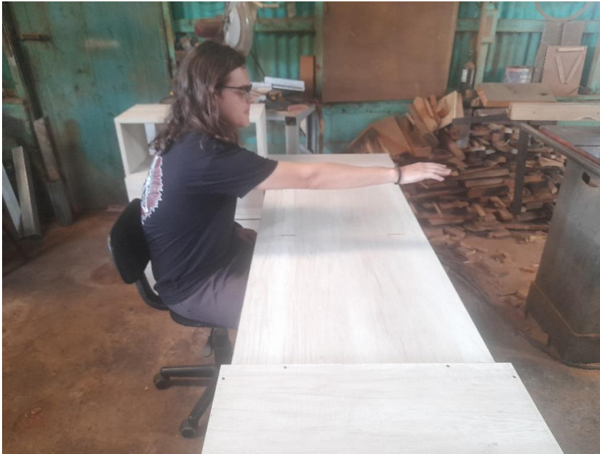
Fig. 85. Comparación de la profundidad del sobre con el largo del brazo (frontal), usuario 2. Elaboración propia.
