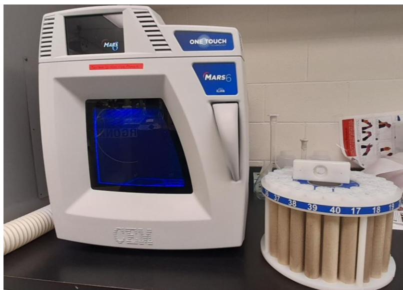
Figura 12. Sistema de digestión de microondas MARS 6 utilizado en el análisis.
