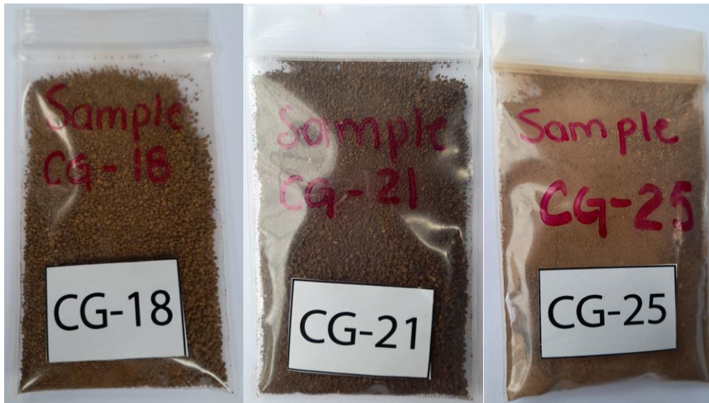
Figura 27. Tres muestras de suelo tamizadas a 1.18 mm del distrito de Palmira, Cañas, Guanacaste.
