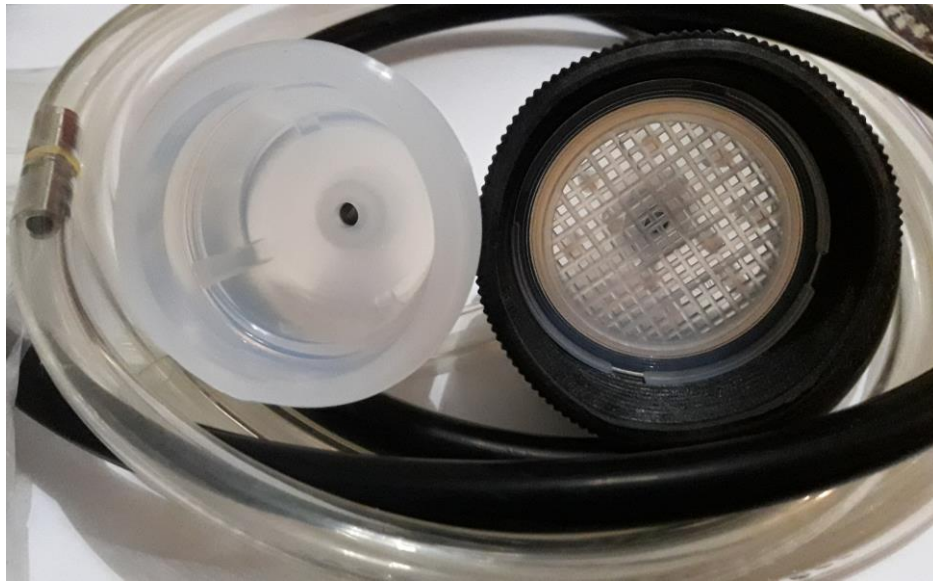
Figura 18. Sector del muestreador por impactación en donde se colocaba el filtro, enviada por el TTU.
