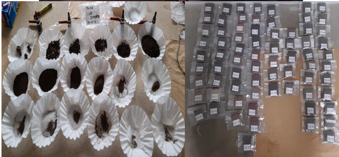
Figura 10. Etapa de tamizado y empaque. Arriba, tamizado de muestras en el laboratorio multiuso de Ingeniería Ambiental, Tecnológico de Costa Rica. Abajo a la izquierda, proceso de tamizado de la muestra CG-58 y a la derecha, 13 g de suelo en cada una de las muestras empaquetadas y listas para enviar al TTU en Estados Unidos.
