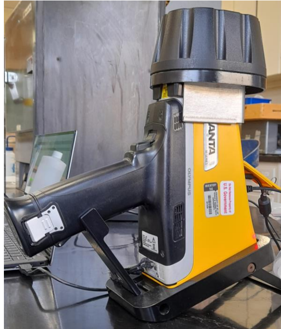
Figura 11. Espectrómetro Olympus serie Vanta M utilizado para los análisis.
