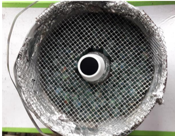
Figura 17. Colector de partículas por gravedad ya ensamblado según las indicaciones del TTU.
