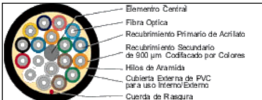
c. Esquema de composición de un cable multifibra
