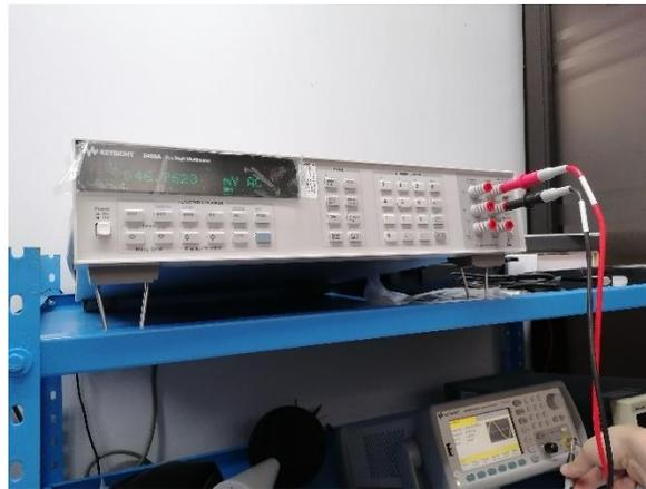
Figura 5. Medición del voltaje en circuito del generador de señales.
