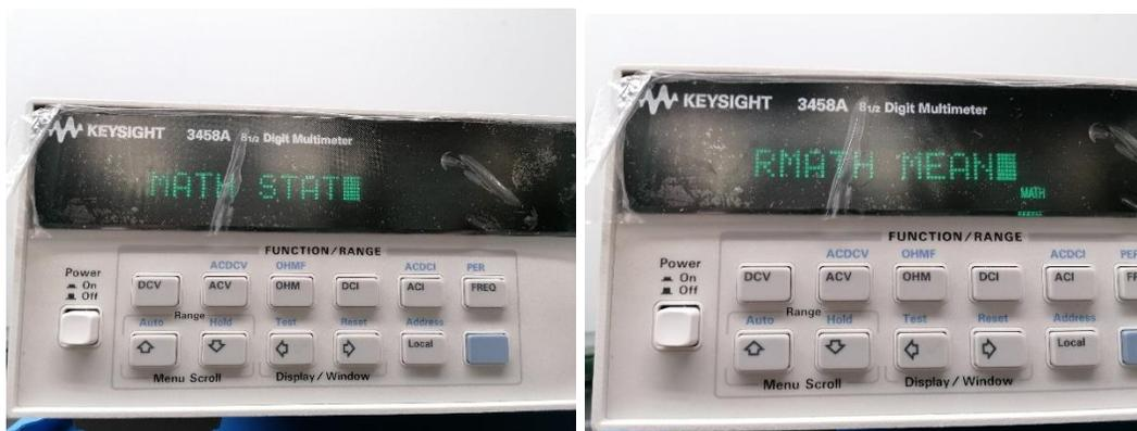
Figura 4. Configuración del multímetro para el cálculo de valores promedio.
