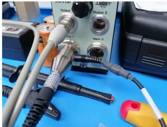
Figura 2. Configuración adecuada para la conexión del multímetro y la unidad de inserción a la fuente de alimentación del micrófono.
