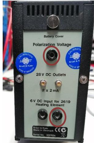
Figura 3. Terminales de la fuente de alimentación necesarias para la medición del voltaje de polarización real.
