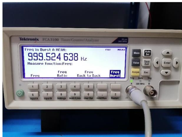
Figura 7. Medición de frecuencia del calibrador acústico utilizando el contador de frecuencias.
