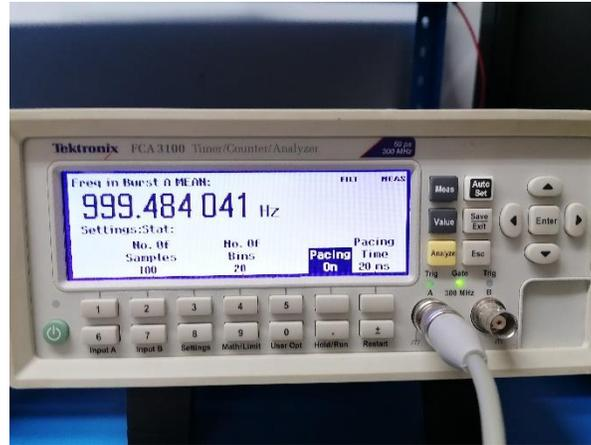
Figura 6. Configuración adecuada para el adecuado funcionamiento del contador de frecuencias.
