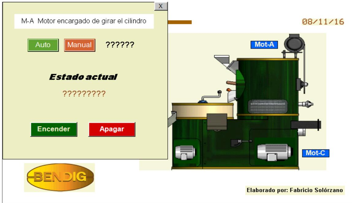
Figura 5.9.2 Representación en el sistema HMI de la lógica de encendido y apagado. Fuente: Elaboración propia.
