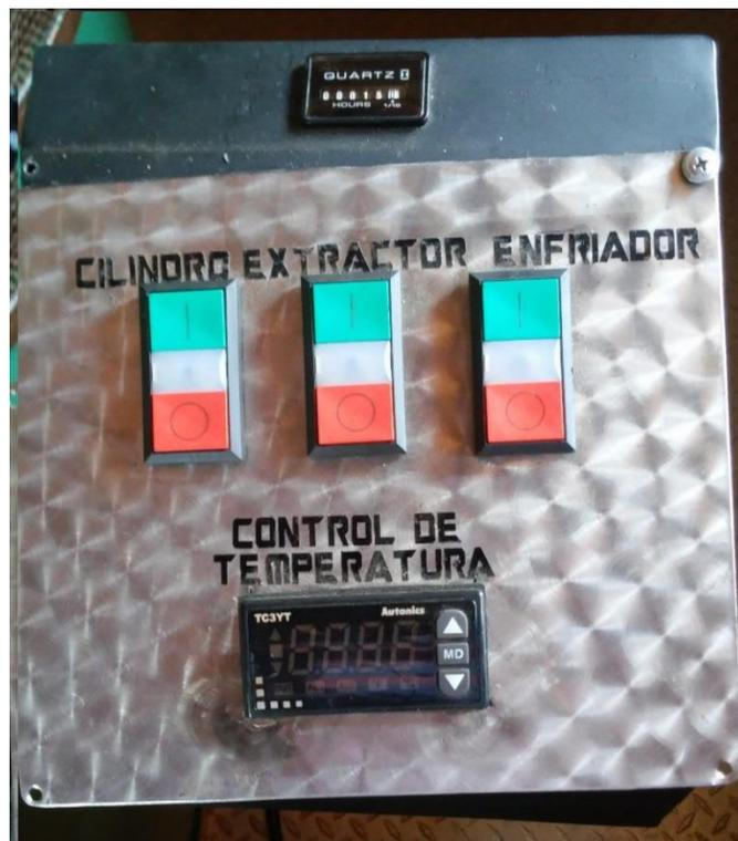
Figura 5.11.1 Panel de control incorporado dentro de la tostadora TE-5. Fuente: Elaboración propia.
