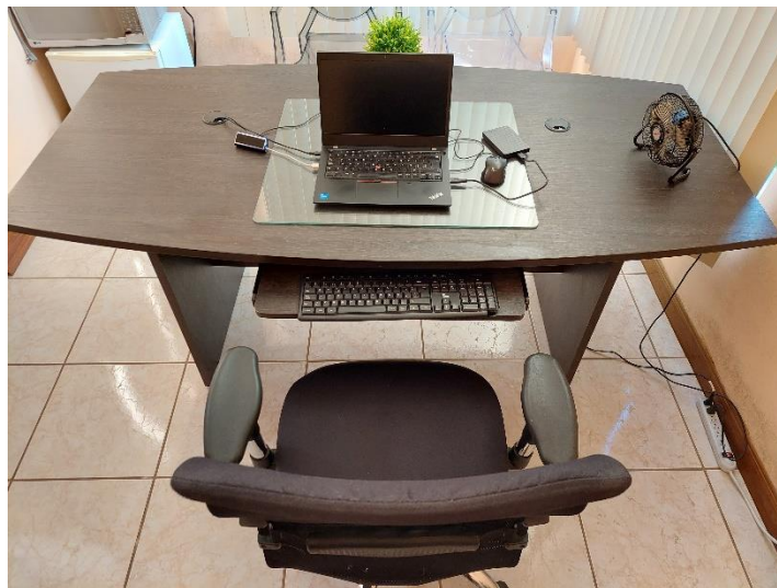
Figura 10. Colocación de un teclado adicional para mejorar la postura en hombros, codos y muñecas. Elaboración propia.
