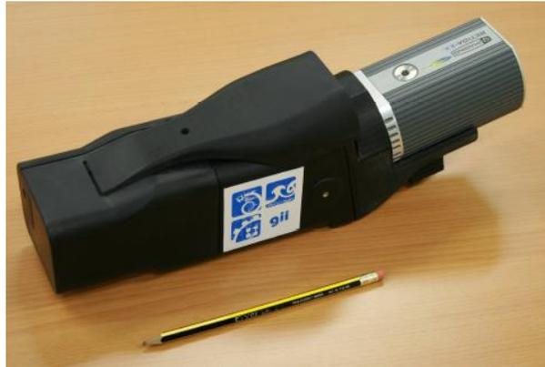
*Figura 2.1-4 Hiperspectrómetro con Cámara Retiga Exi. Extraído de (Priego Torres, 2011)*
