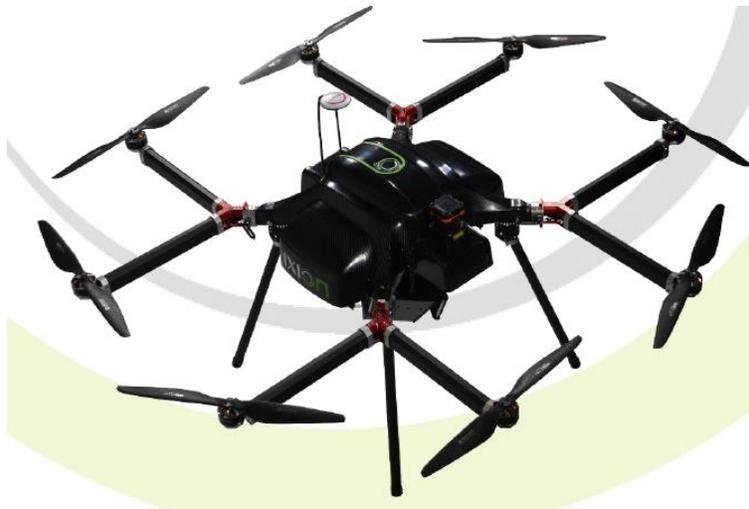
Figura 3.9-2 Octocóptero marca Ixion. Extraído de (Ixion, 2016)
