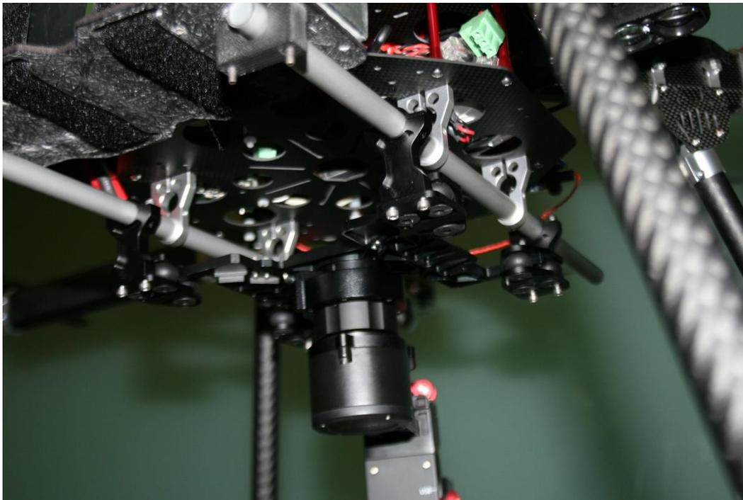
Figura 3.9-5 Detalle de Acople Octocóptero marca Ixion y Gimbal CAME Mini 3-air. Tomado con Cámara Canon EOS 400D
