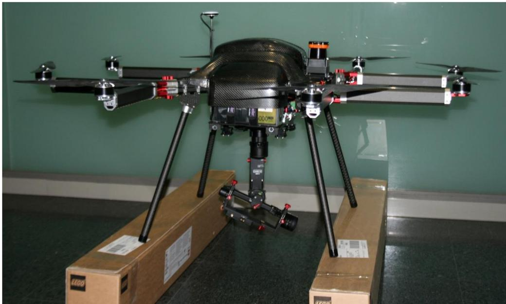
Figura 3.9-4 Octocóptero marca Ixion y Gimbal CAME Mini 3-air Acoplados. Tomado con Cámara Canon EOS 400D
