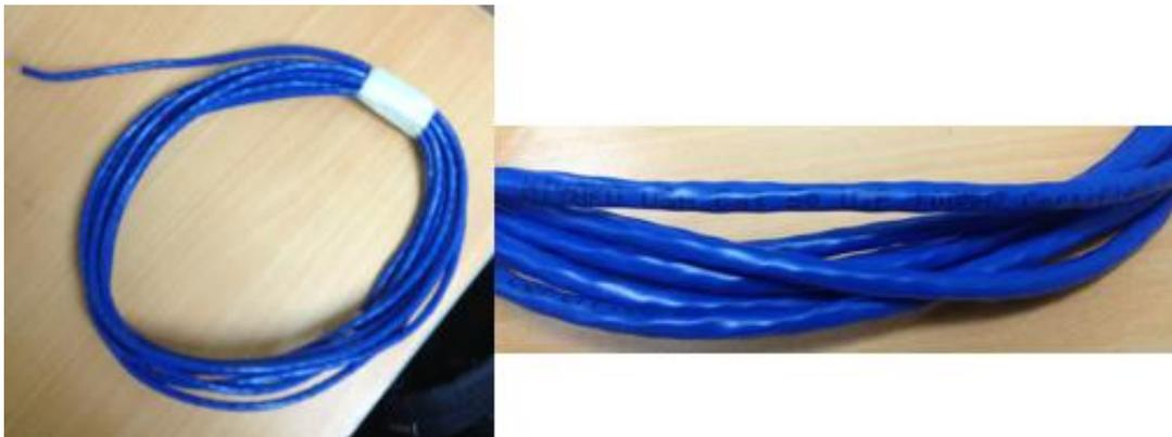
Figura 6.8. Cable Miyako USA Cat. 5e UTP seleccionado para realizar la conexión eléctrica (Elaboración propia).
