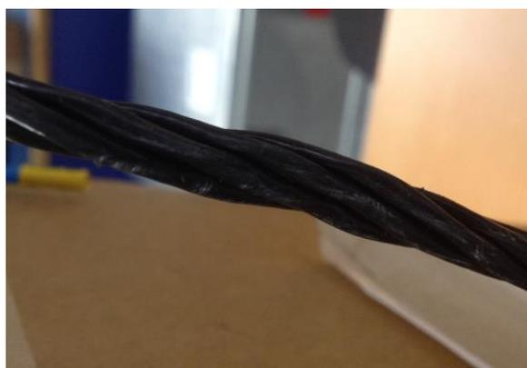
Figura 6.6. Cable UTP del brazo robótico con señales de desgaste (Elaboración propia).
