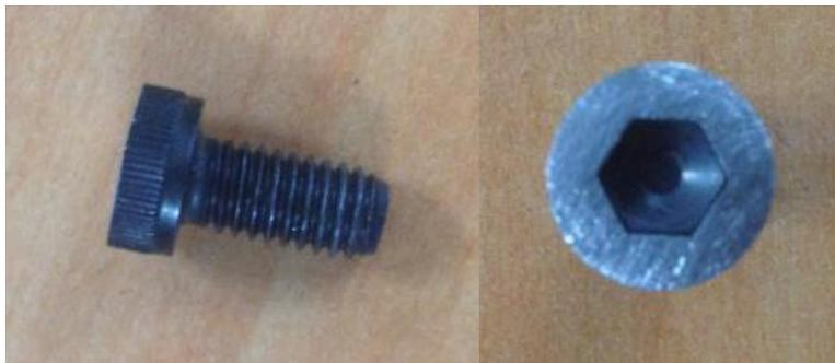
Figura 5.21. Tornillos esmerilados para la reducción de la longitud de la cabeza (Elaboración propia).
