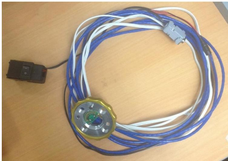
Figura 6.16. Conexión eléctrica final para la alimentación, control y paro de emergencia de la mano robótica DLR HIT Hand II (Elaboración propia).
