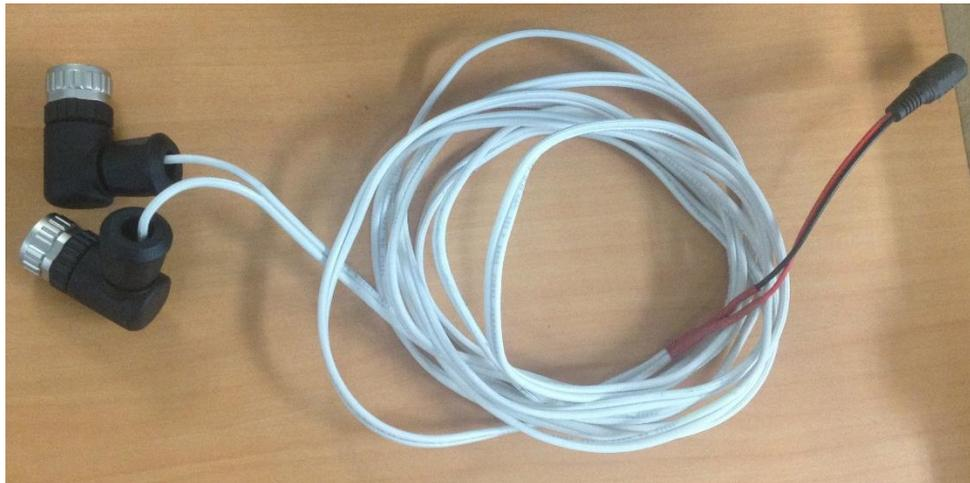
Figura 6.14. Conexión implementada entre la fuente de alimentación de la mano robótica y los cables interno del brazo (Elaboración propia).
