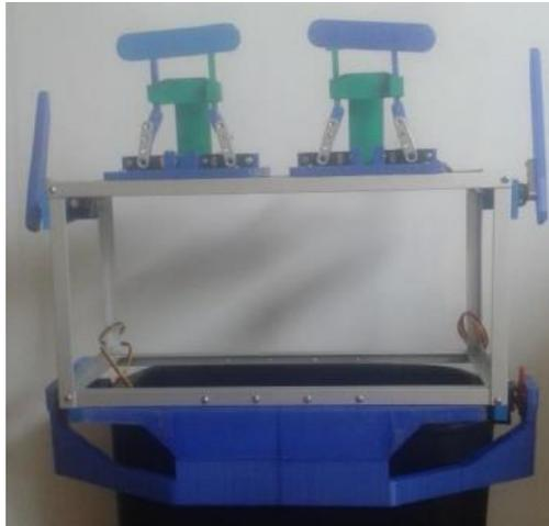
Figura 3.15. Prototipo de la cabeza y cara emocional del robot humanoide (Herrera, 2016).
