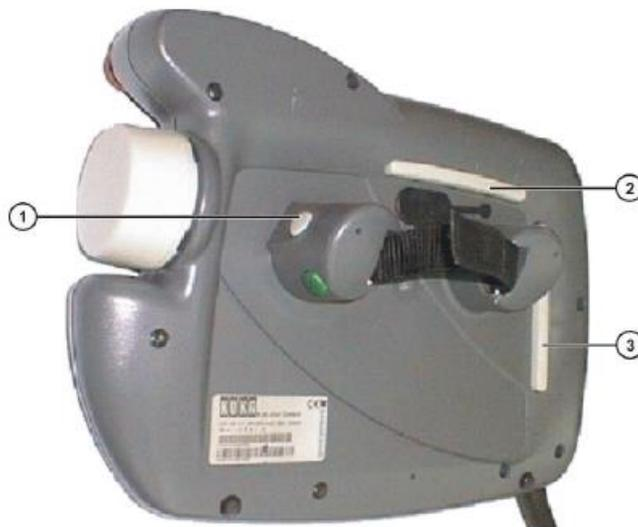
Figura 7.4. Interruptores de activación del “teach pendant” (KUKA Roboter, 2011).
