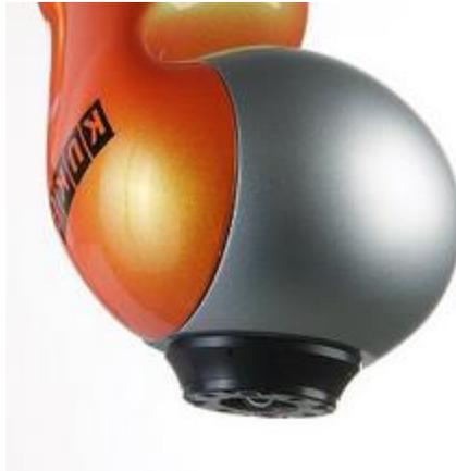
Figura 5.4. Zona de acople del efector final al brazo robótico (Universidad Aalto, 2013).
