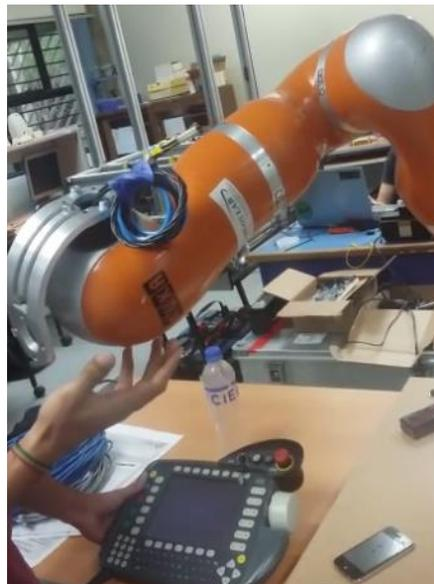
Figura 9.25. Compensación de una herramienta con los valores de TCP y peso correctos (Elaboración propia).
