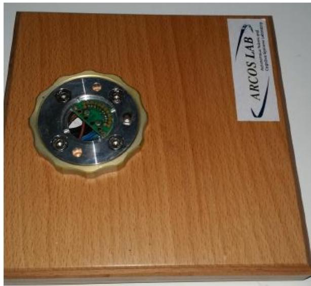
Figura 6.1. Base diseñada para soporte de la mano robótica (Ruiz & Chinchilla, 2016).
