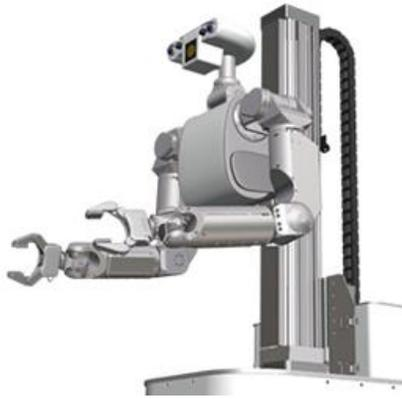
Figura 2.11. Tipo de torso móvil en robots humanoides (Elaboración propia basada en Burón (2011)).
