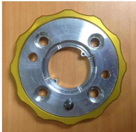
Figura 5.8. Pieza de sujeción para la mano robótica DLR HIT Hand II (Elaboración propia).
