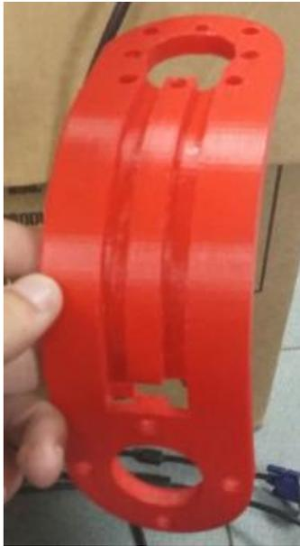
Figura 5.6. Prototipo 3D de la pieza de acople entre el brazo y la mano robótica (Elaboración propia).
