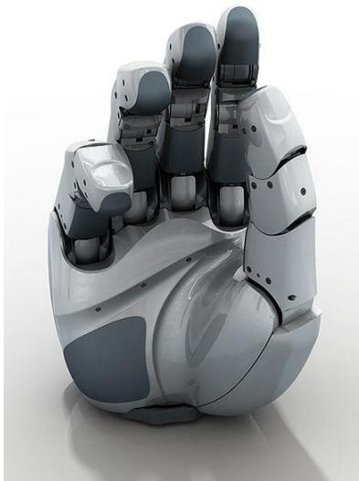
Figura 3.13. Mano robótica DLR HIT Hand II presente en el ARCOS-Lab (Instituto de robótica y mecatrónica, 2008).
