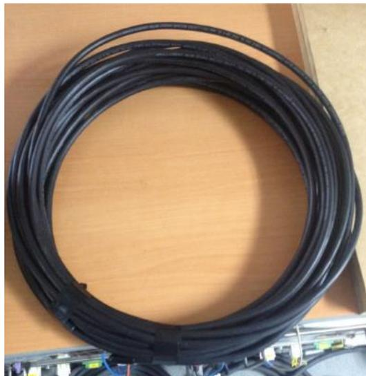
Figura 6.7. Cable UTP CAT 5e para exteriores (Elaboración propia).
