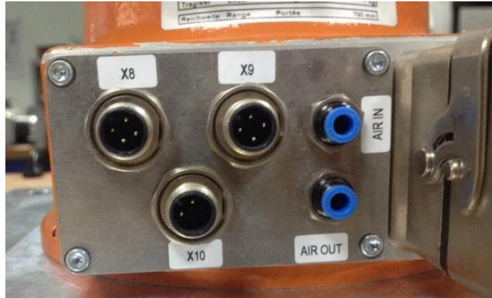
Figura 6.11. Panel de la base del brazo y pines utilizados para la alimentación de la mano robótica (Elaboración propia).
