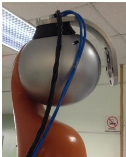
Figura 6.5. Conexiones internas existentes en el brazo robótico del ARCOS-Lab (Elaboración propia).
