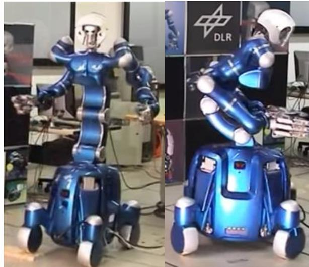
Figura 9.1. Movimiento realizado por el torso del robot Rollin' Justin (Deyle, 2009).
