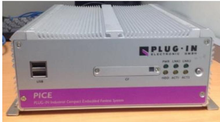
Figura 3.14. Controlador de la mano robótica DLR HIT Hand II (Elaboración propia).
