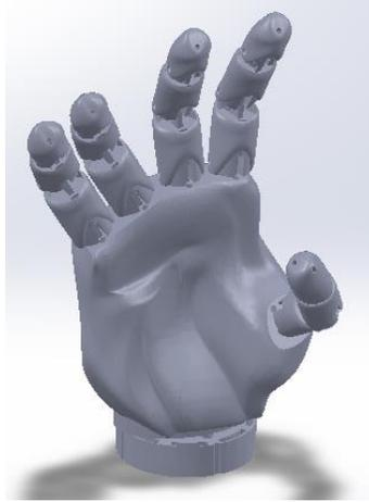
Figura 7.13. Modelo encargado de representar la mano DLR HIT Hand II (Elaboración propia).
