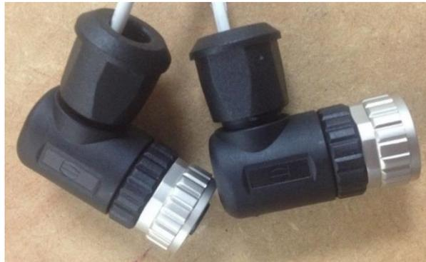
Figura 6.12. Conectores utilizados para tener acceso a los cables internos del brazo robótico (Elaboración propia).
