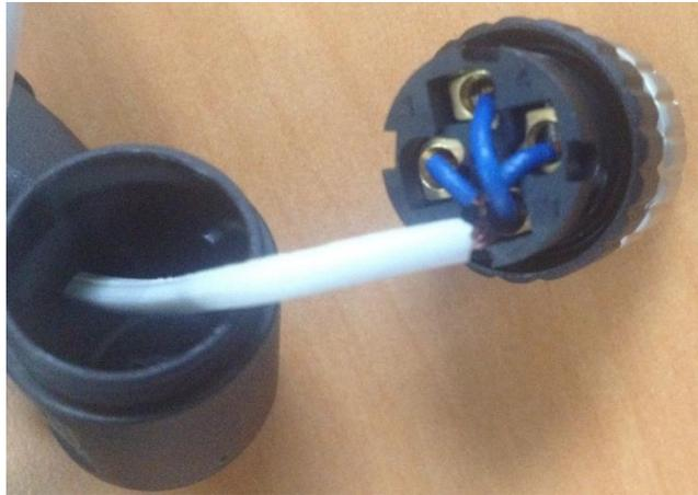
Figura 6.13. Conexión eléctrica dentro del conector Harting, realizada para dos pares de cables trenzados (Elaboración propia).
