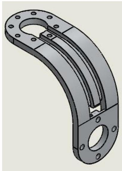
Figura 5.5. Primer modelo de la pieza de acople entre el brazo y la mano en Solidworks (Elaboración propia).
