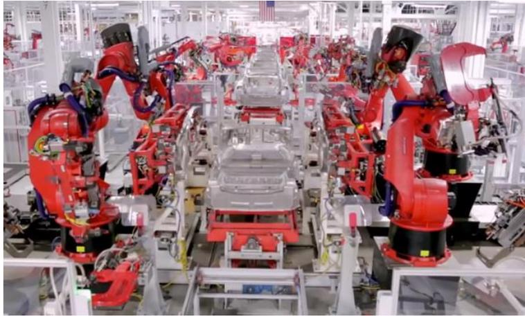
Figura 2.4. Línea de producción automatizada para el ensamble de un automóvil eléctrico Tesla (Urbina, 2014).
