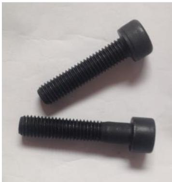
Figura 5.34. Tornillos empleados para la sujeción entre placas de madera y la placa metálica del brazo (Elaboración propia).
