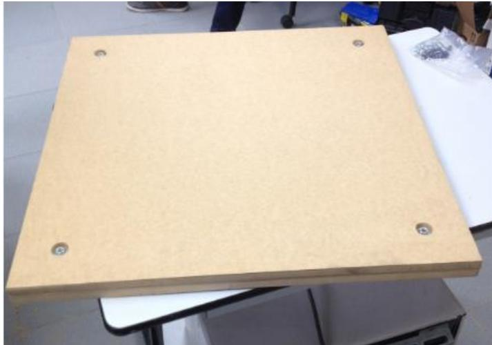
Figura 5.33. Unión entre las dos placas de madera vista desde la parte inferior (Elaboración propia).
