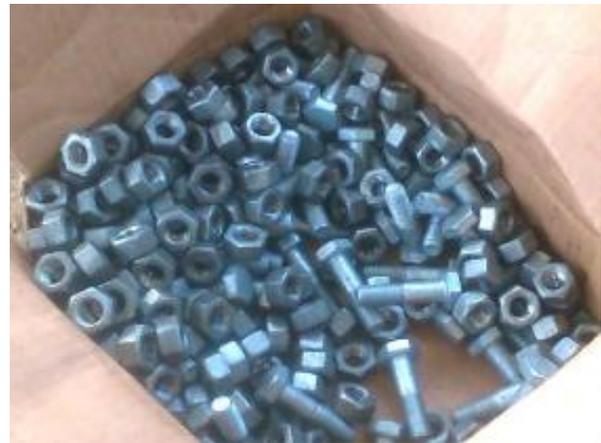
**Figura 19.** Pernos de unión para los paneles del tanque.
