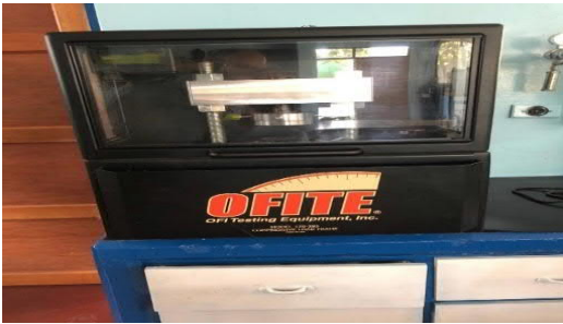
Figura 7 Segunda máquina de falla de cubos
