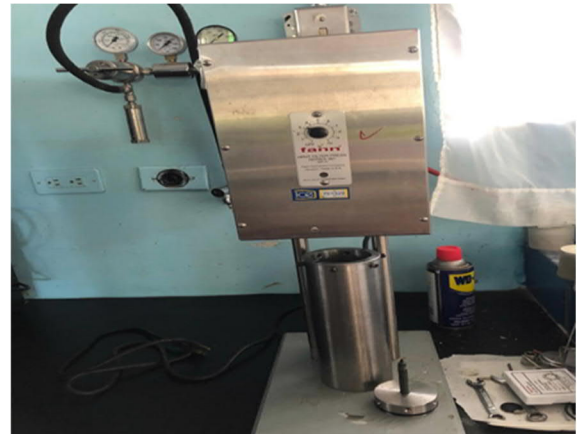
Figura 10 Prensa filtro alta temperatura y presión
