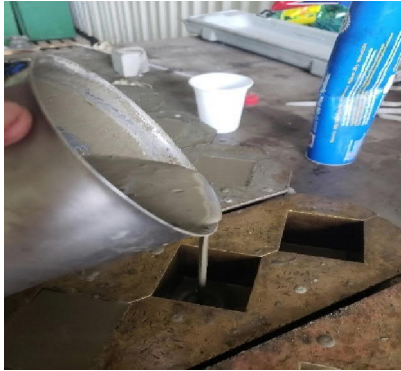
Figura 15 Fin de llenado de moldes
