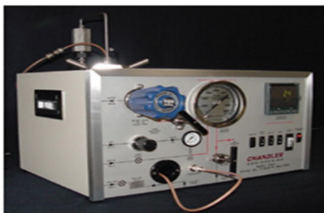
Figura 16 Unidad ultrasónica de resistencia a la compresión ensayo no destructivo
