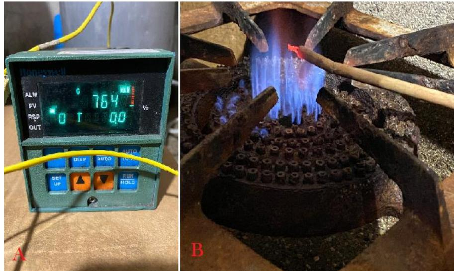
**Figura 1** Equipo para medición de temperatura de llama de biogás.
