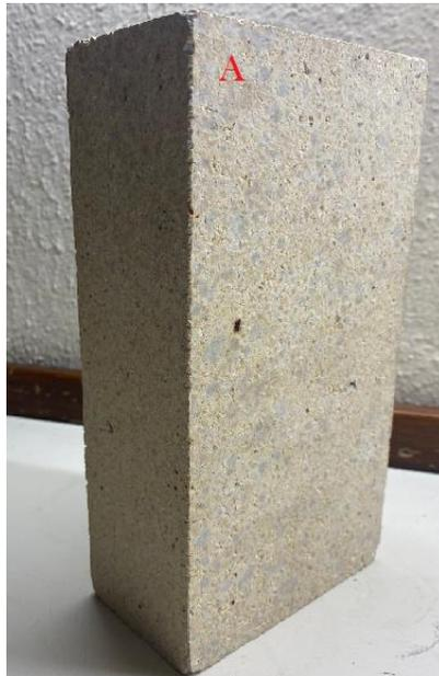
**Figura 4** Superficie de ladrillo refractario expuesta a fuente de calor para prueba de conductividad térmica.
