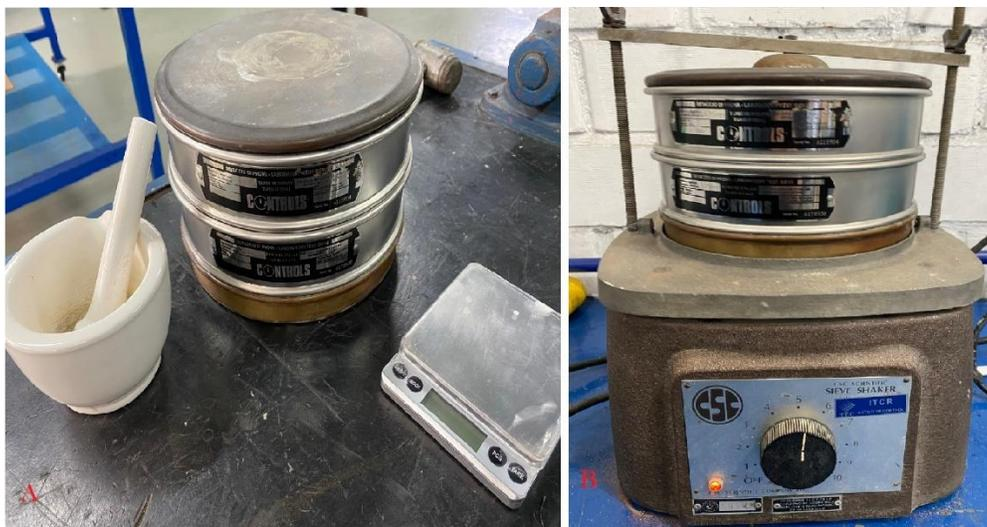
**Figura 3** Equipo para prueba de homogenización de partículas.
