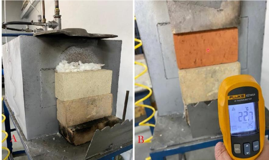
**Figura 5** Montaje de ladrillos para exposición a fuente de calor.
