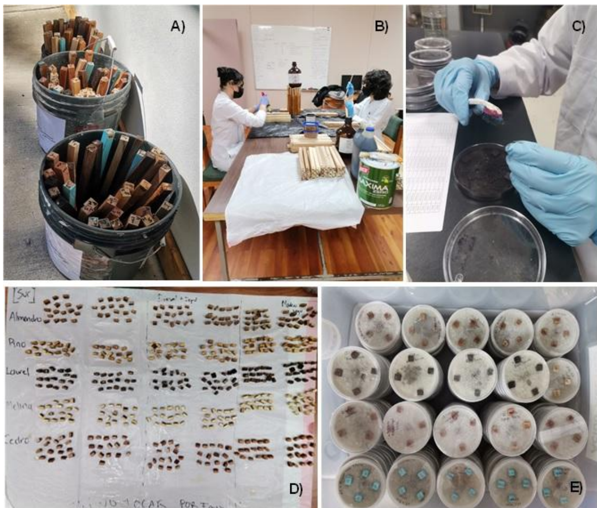
Figura 5. Diferentes etapas en el establecimiento y evaluación de los ensayos de biodeterioro. A) Cementerio de estacas en el barrio Jamaica Town. B) Aplicación de los tratamientos en las piezas de 2x2x30cm. C) Limpieza de las piezas de 0,5x0,5x1cm al finalizar las 14 semanas de incubación. D) Aplicación de los tratamientos en las piezas de 0,5x0,5x1cm. E) Platos petri con el hongo L. theobromae y las piezas con tratamientos.
