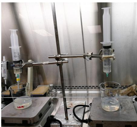
**Figura 3.2.** Goteo de disolución de alginato de sodio 2 % a través de jeringa de 60 mL
