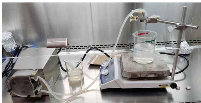
**Figura 3.1.** Arreglo experimental para la formación de cápsulas de alginato de calcio
