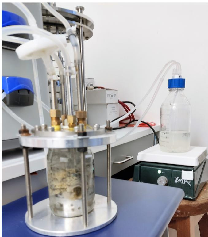
**Figura 3.3.** Arreglo experimental al acoplar el prototipo de reactor de biopelícula desarrollado con un reactor con microorganismos inmovilizados en cápsulas de alginato de calcio en suspensión
