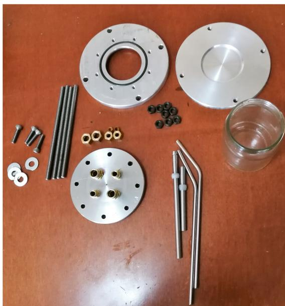
**Figura 4.16.** Componentes relevantes en el maquinado y recipiente de aireación
