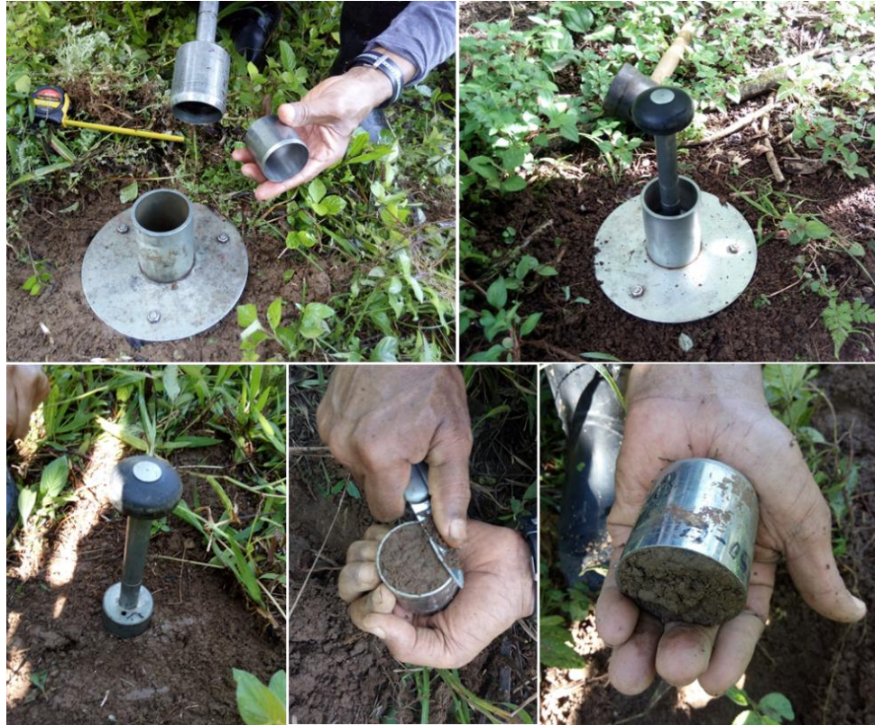
Figura 5. Materiales usados y procedimiento empleado en la toma de muestras para medir la densidad aparente. 2019 – 2020.
