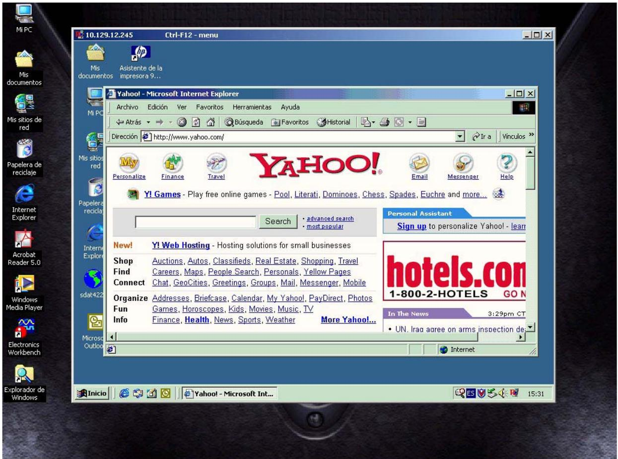
**Figura 6.1.** Explorador de Internet ejecutado de manera remota. La computadora cliente tiene el escritorio en color negro, mientras que la computadora servidor lo tiene en celeste.
