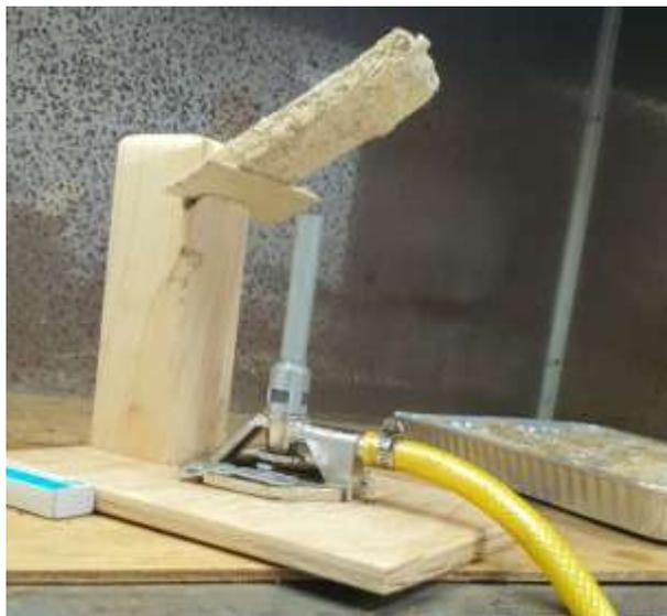
**Figura 3.** Mecanismo diseñado para la prueba de resistencia de fuego.
