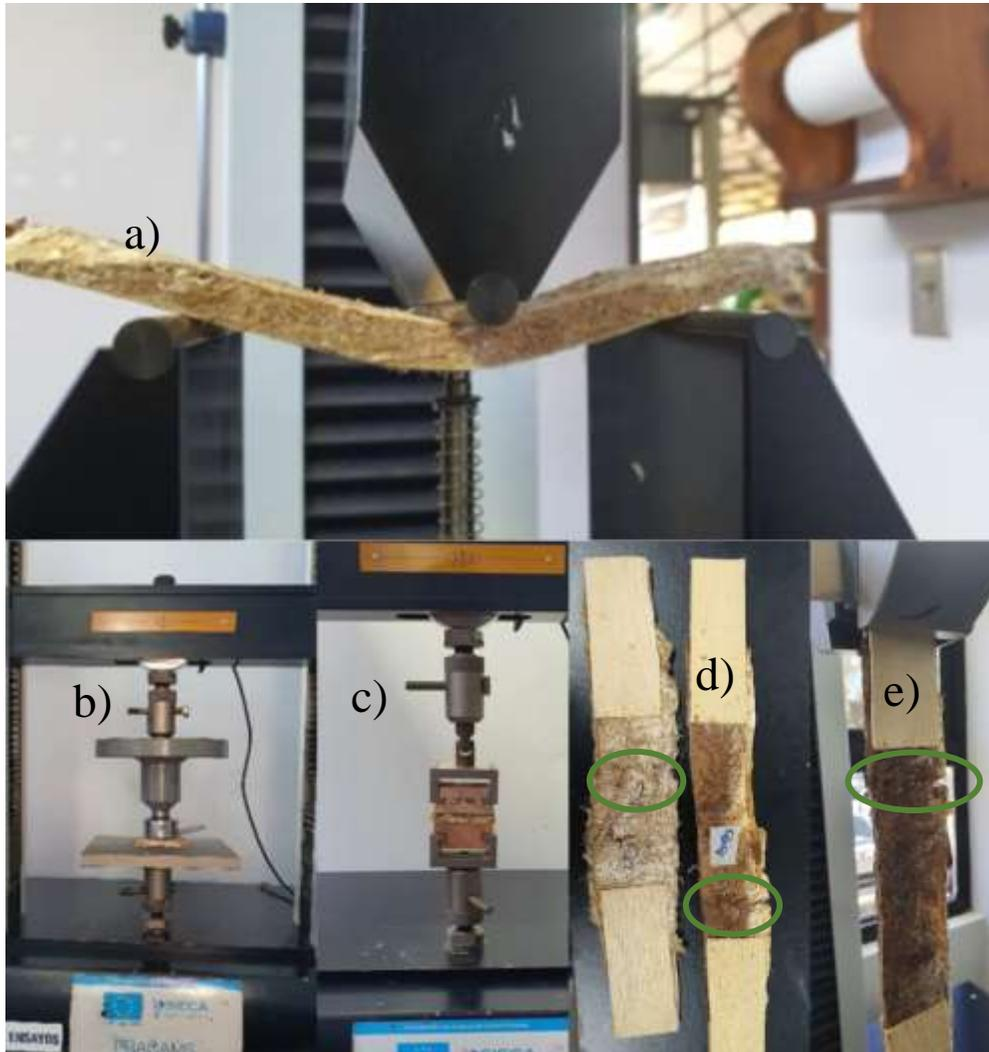
**Figura 4.** Ensayos mecánicos realizados según la norma ASTM D1037.
