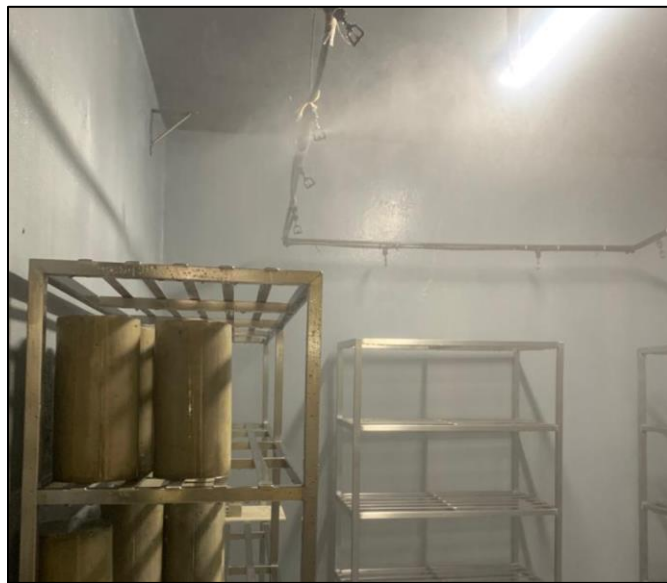
Figura 2.1 Vista interna del cuarto húmedo en el Centro de Investigaciones en Vivienda y Construcción (CIVCO), mostrando probetas de concreto y aspersores en funcionamiento.
