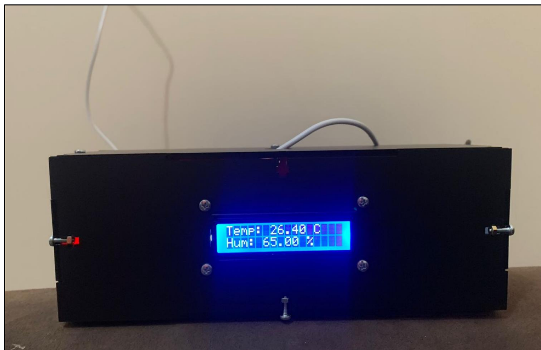
Figura 4.18 Vista frontal del prototipo con la pantalla LCD 1602 en funcionamiento, exhibiendo datos en tiempo real de temperatura y humedad. Fuente: Elaboración propia.
