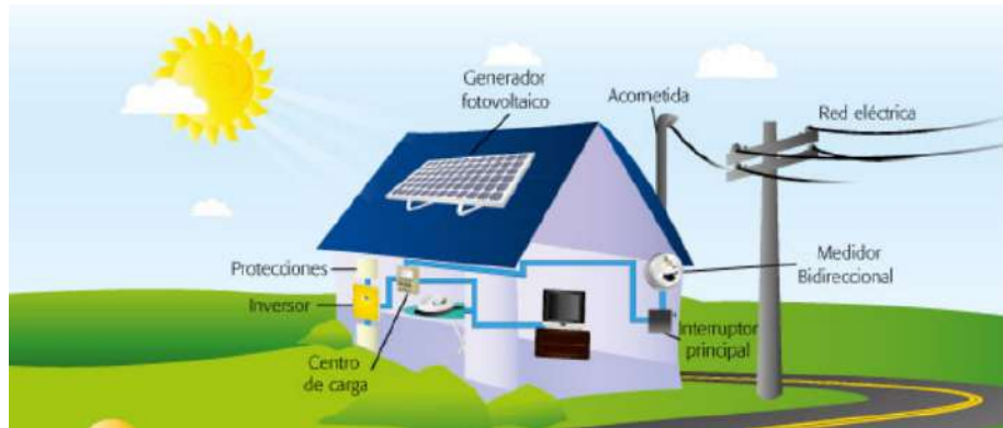
Figura 2.9: Diagrama de conexión de panel solar entre casa y red eléctrica Fuente: Tomado de (Grupo ICE, s.f.)
