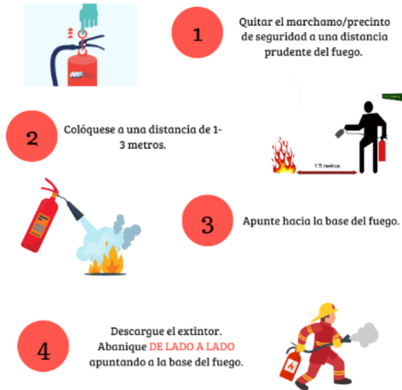
Figura 1. Pasos para utilizar un extintor portátil.
