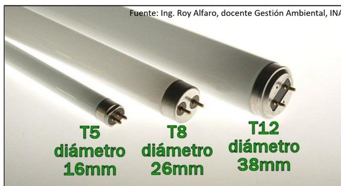
**Figura 5.10:** Tipos de tubos fluorescentes lineales [12].
