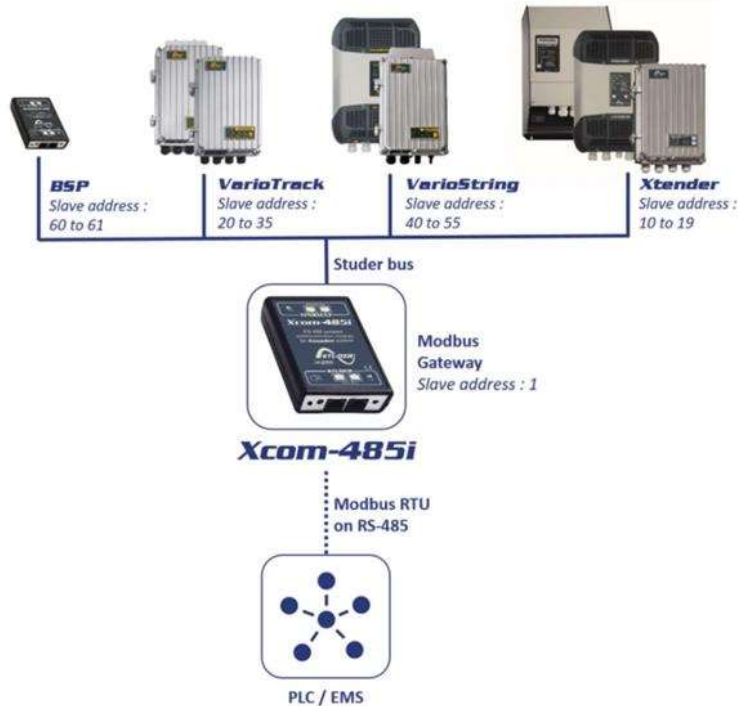
Figura 39. Direccionamiento Modbus RTU EIA RS-485, para la red de dispositivos utilizados en el inversor híbrido referencia bibliográfica [11]
