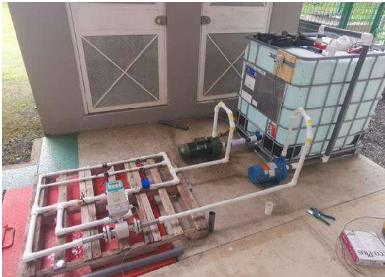
Figura 67. Fotografía parcial del equipo experimental PAT, de la planta recuperadora de energía potencial a implementar por el ITCR, en Ingeniería en Electrónica en la sede de San Carlos.
