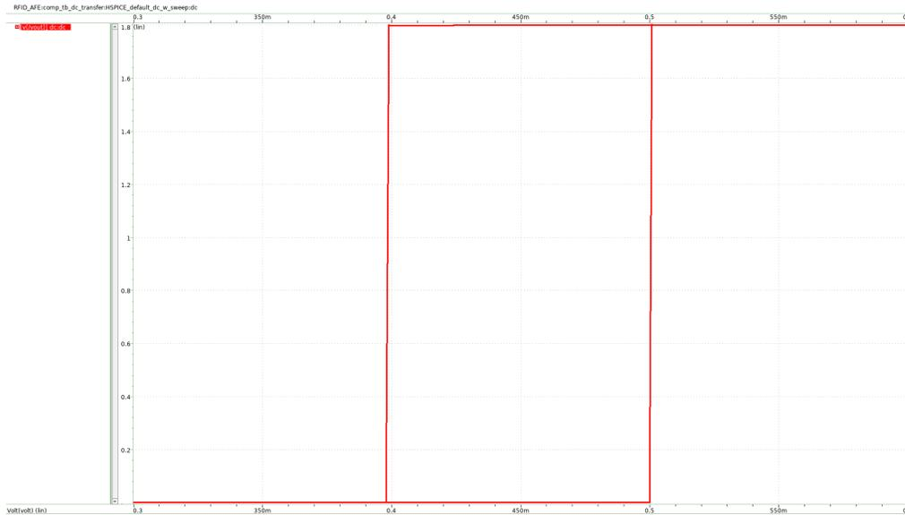
Figura 6.11: Respuesta de transferencia del comparador mostrando la histéresis
