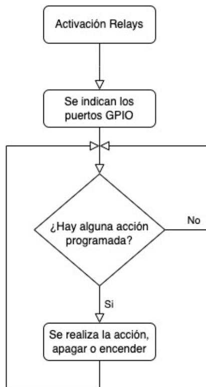
**Figura 3.9:** Diagrama de flujo para la activación de los relays.
