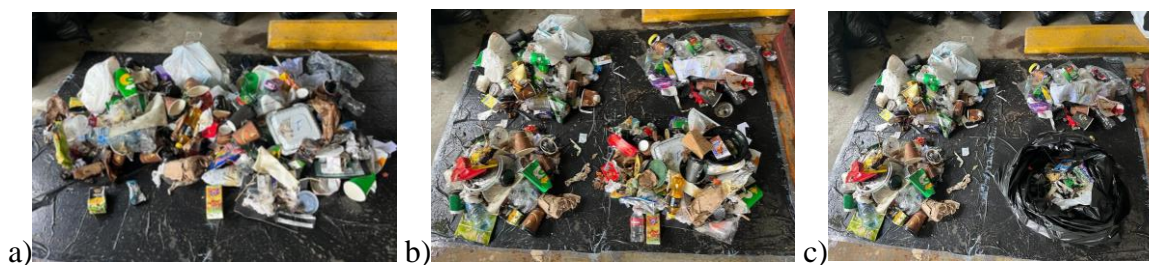
Figura 3.3 Metodología seguida para el cuarteo de las bolsas muestreadas.
