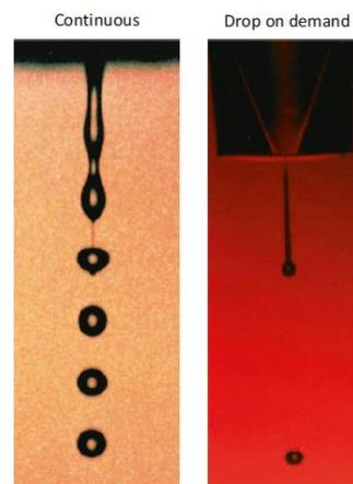
Figura 12. Deposición por goteo continua y a demanda. Tomado de: (Gibson et al., 2020)
