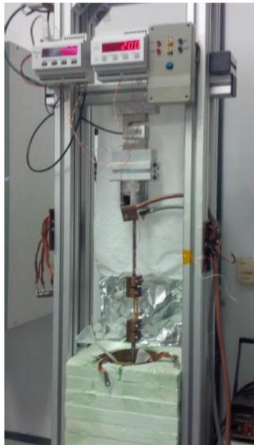
Figura 21. Máquina de ensayos universales con cámara ambiental colocada en su base. Tomado de: (Bartolomé et al., 2017).
