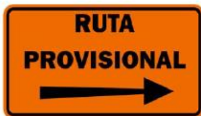
Figura 9. Señalamiento vial temporal que indica desvío adelante
