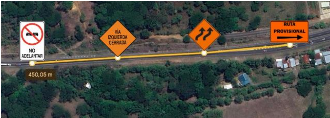
Figura 19. Imagen satelital de intercambio de la Ruta Nacional n.º.27 midiendo 450 metros mínimos que se deben cumplir según el Manual Centroamericano de Dispositivos Uniformes para el Control del Tránsito (2015) con separación de 150 metros entre señales y señalamiento vial escogido
