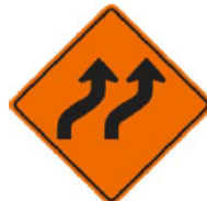
Figura 19. Señalamiento vial temporal que indica desvío de ambos carriles hacia la derecha
