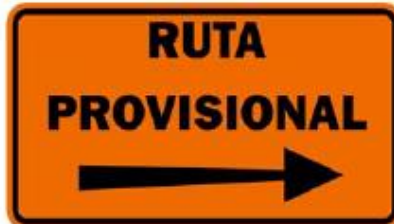
Figura 47. Señalamiento vial temporal que indica desvío adelante
