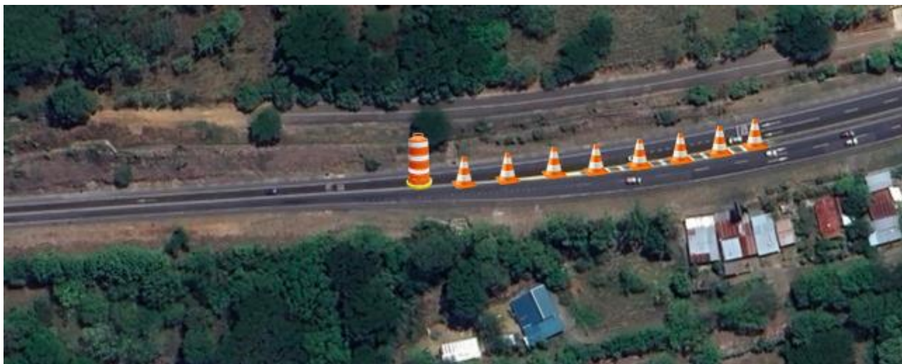
Figura 20. Imagen satelital de intercambio de la Ruta Nacional n.º.27, colocando “tappers” con una longitud mínima de 120 metros
