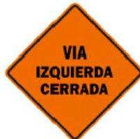
Figura 18. Señalamiento vial temporal que indica vía izquierda cerrada
