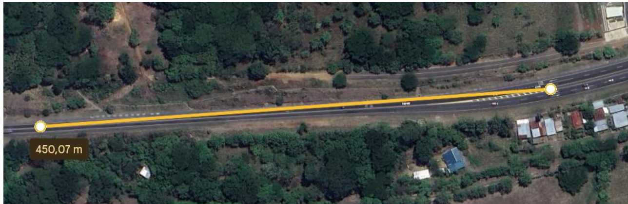
Figura 18. Imagen satelital de intercambio de la Ruta Nacional n°.27 midiendo 450 metros mínimos que se deben cumplir según el Manual Centroamericano de Dispositivos Uniformes para el Control del Tránsito (2015)
