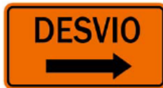
Figura 8. Señalamiento vial temporal que indica desvío adelante
