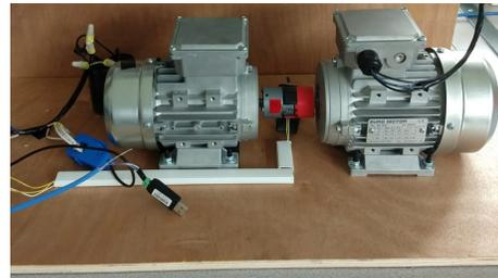
(a) Conexiones de los dispositivos al NI myDAQ (b) Motores acoplados y convertidor USB - RS485
