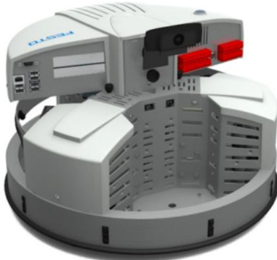
Figura 4.16. Ubicación de interfaz de entradas y salidas del Robotino® de Festo. Fuente: [49]
