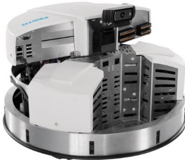
Figura 2.3. Robot móvil Festo Robotino®. Fuente: [6]
