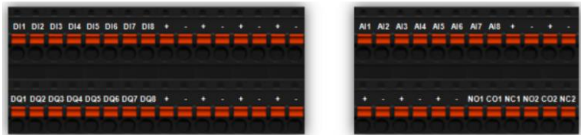
Figura 4.15. Interfaz de entradas y salidas del Robotino® de Festo. Fuente: [49]
