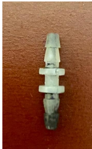
Figura 4.14. Punta de goteo utilizada para deposición de la sustancia. Fuente: Elaboración propia.
