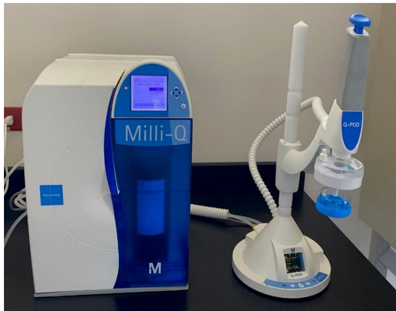
Figura 5.1. Equipo purificador de agua MILLI-Q® ADVANTAGE A10® SYSTEM . Fuente: Elaboración propia
