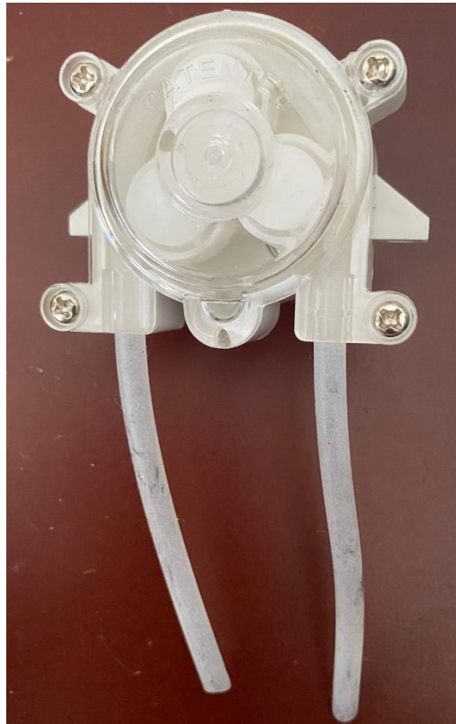
Figura 4.6. Primer concepto de solución para bombeo de sustancia. Fuente: Elaboración propia.
