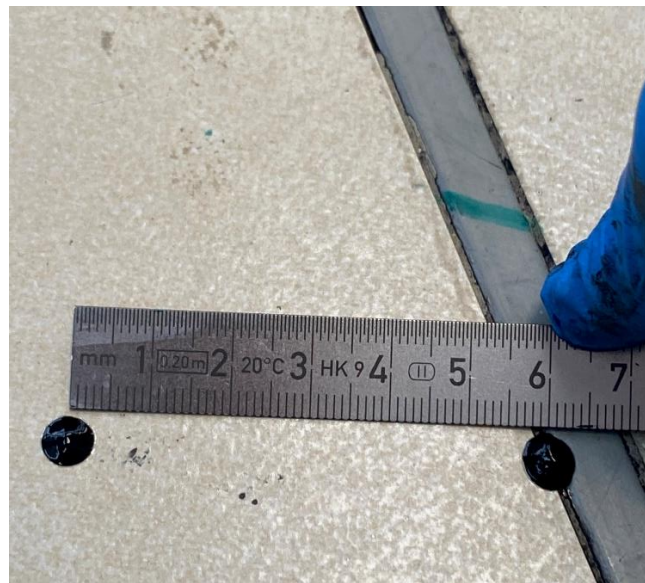
Figura 5.7. Método de medición de distancias entre gotas. Fuente: Elaboración propia
