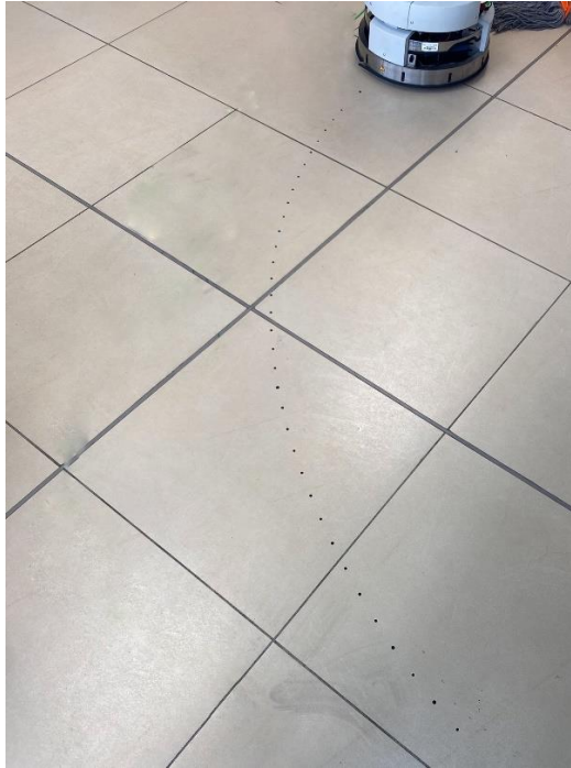
Figura 5.4. Trayectoria en forma de arco utilizada para las pruebas. Fuente: Elaboración propia
