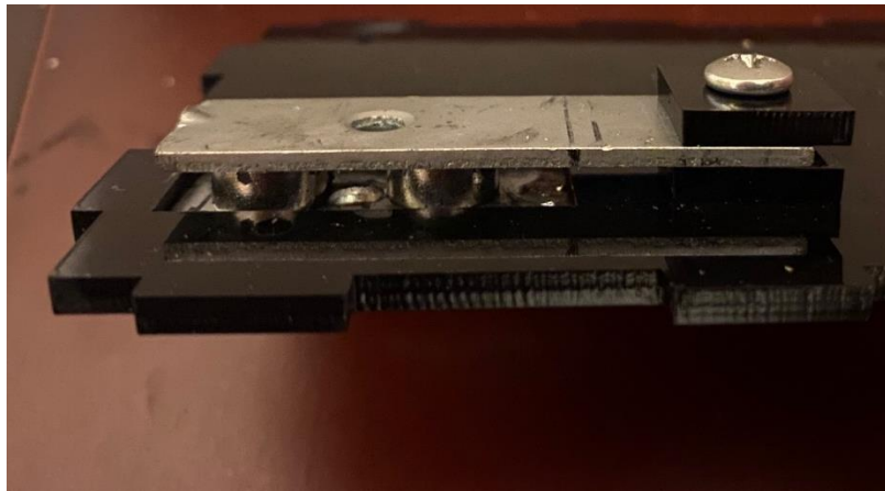
Figura 4.46. Placa para fijación de magnetos a carcasa. Fuente: Elaboración propia
