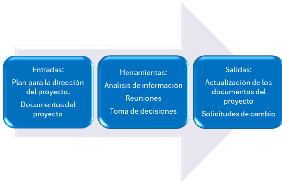
Figura 5-35 Esquema de entradas, herramientas y salidas para la implementación de respuesta a los riesgos durante el proceso de ejecución.
