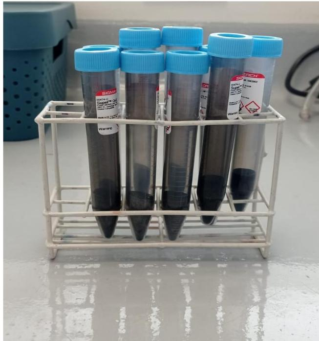
**Figura A 2.5 Tubos QuEChERS para extracción en fase sólida.**
