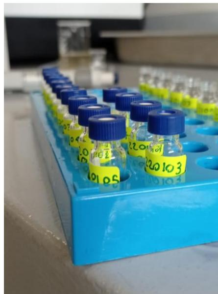
**Figura A 2.6 Viales de 2 mL listos para la inyección programada en el equipo GC-MS.**
