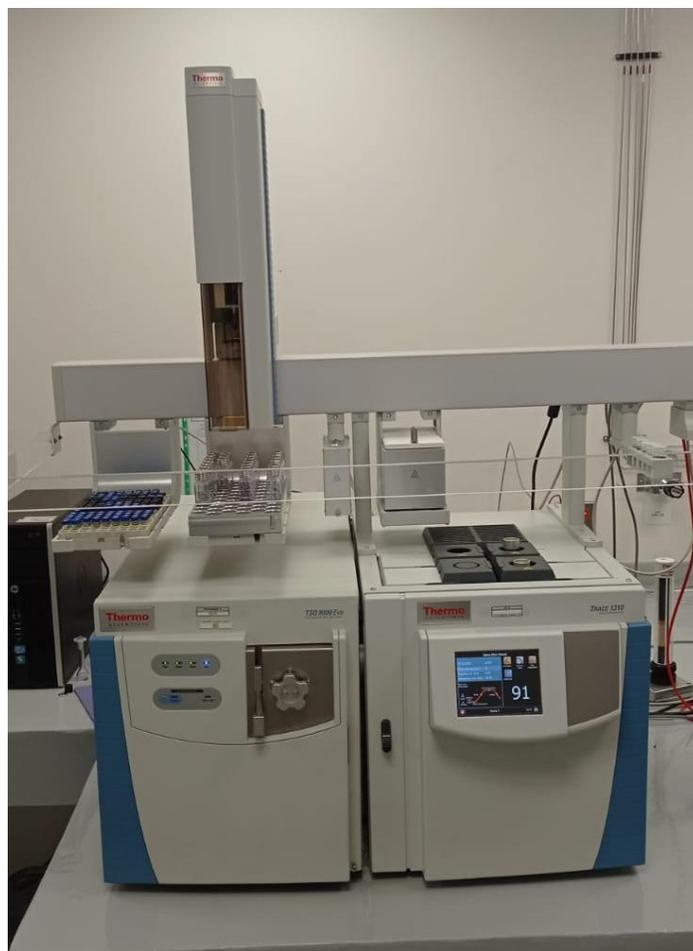
Figura A 2.7 Cromatógrafo de gases acoplado a espectrómetro de masas marca Thermo Scientific.
